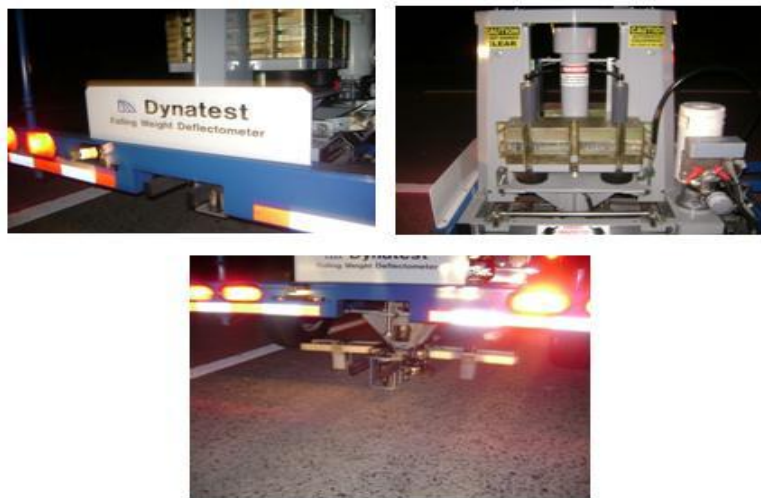
Figura 2.13 Deflectómetro de impacto (FWD) DYNATEST MODELO 8000."MOP-UIDV"
