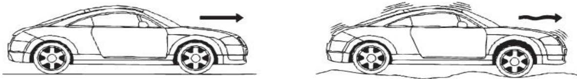
Figura 5.2 Efecto de la regularidad superficial en el confort sentido por los usuarios de la ruta
