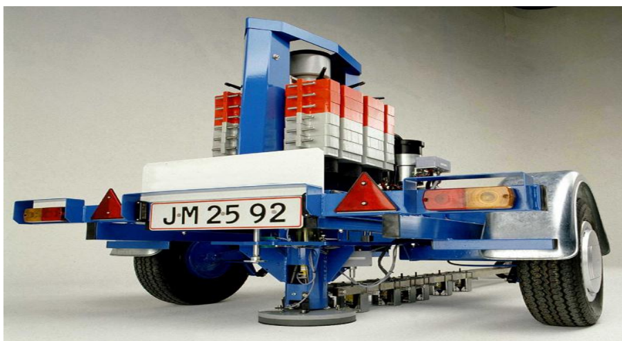
Figura 2.14 Aplicación de carga del deflectómetro de impacto fwd dynatest 8000.
