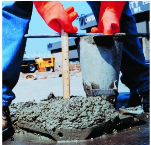
Figura 2.8.9. Ensayo de revenimiento (asentamiento en cono de Abrams) para la consistencia del concreto. La Figura A muestra un revenimiento más bajo, la Figura B muestra un revenimiento mayor.
