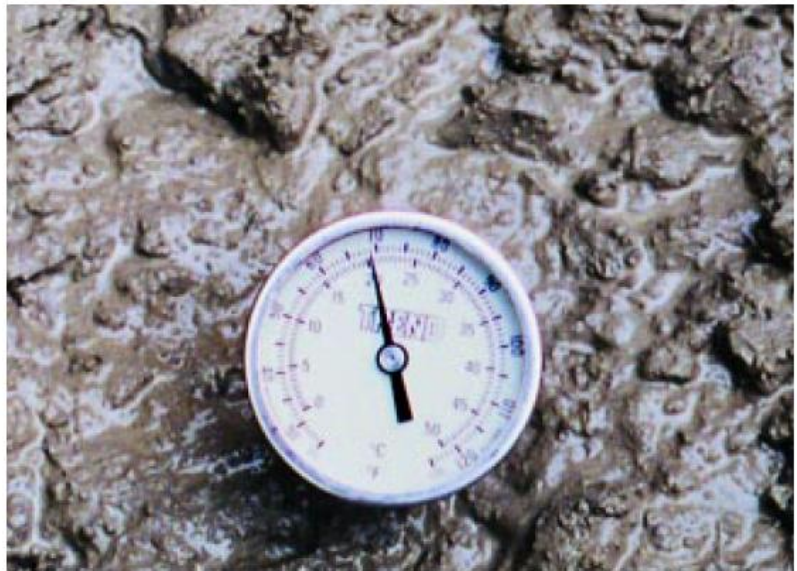
Figura 2.8.10. Termómetro que mide la temperatura del concreto en estado fresco.
