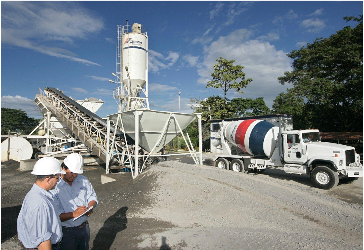
Figura 2.2.2: Producción de Concreto en planta.
