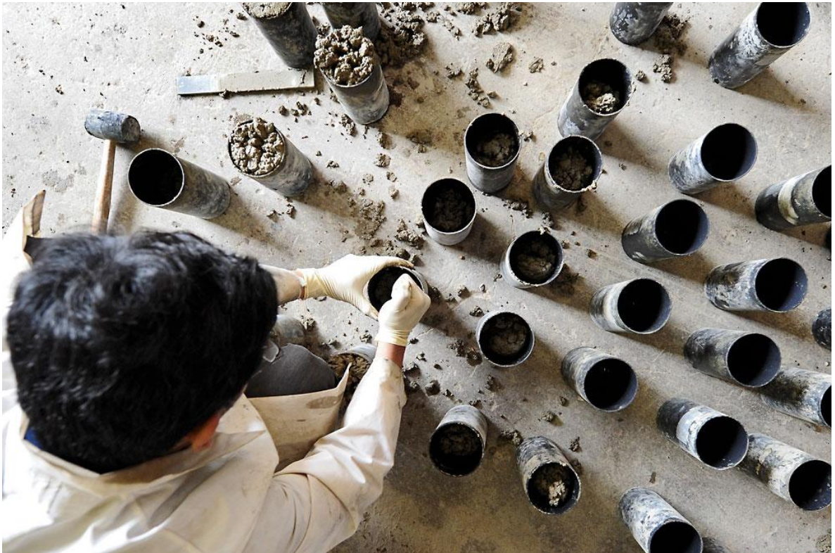
Figura 2.8.13. Preparación de los especímenes estándar para la prueba de resistencia a compresión del concreto utilizando un tipo de moldes artesanales no muy recomendados.
