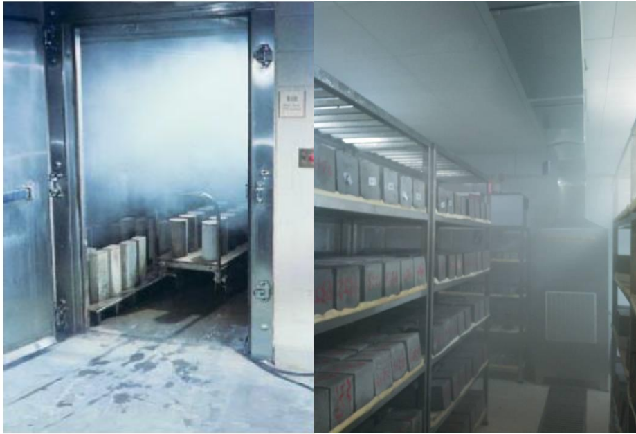
Figura 2.8.15. Curado húmedo controlado en laboratorio de especímenes estándar con humedad relativa de 95% a 100% y temperatura de 23\pm 2^{\circ}\text{C} ( 73\pm 3^{\circ}\text{C} ) (ASTM C 511 o AASHTO M 201).
