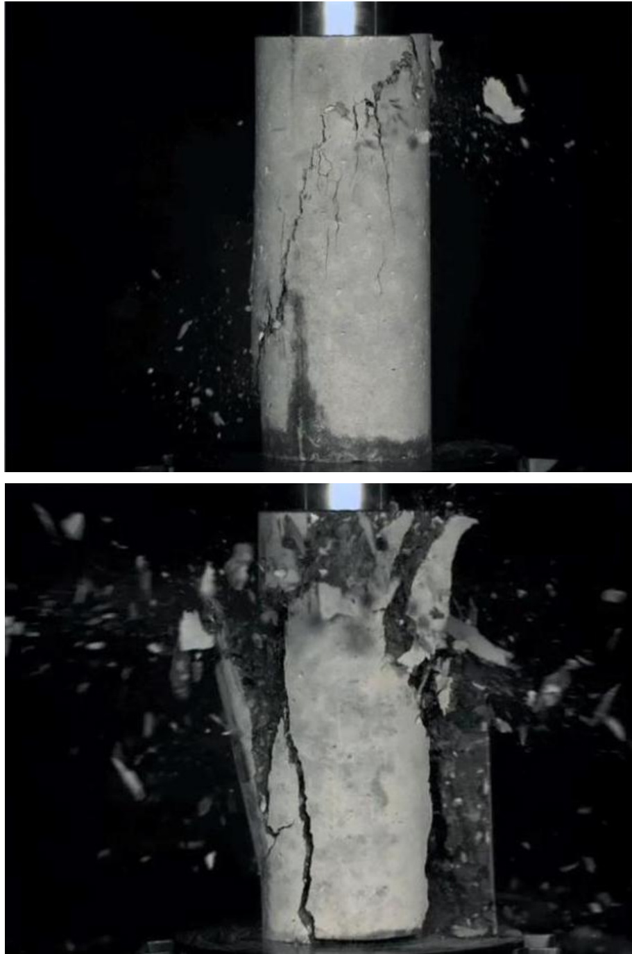
Figura 2.8.4. Las imágenes exponen los tipos comunes de fallas a compresión del concreto de alta resistencia.
