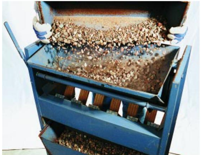
Figura 2.8.8. Proceso de cuarteo mecánico de agregado grueso.
