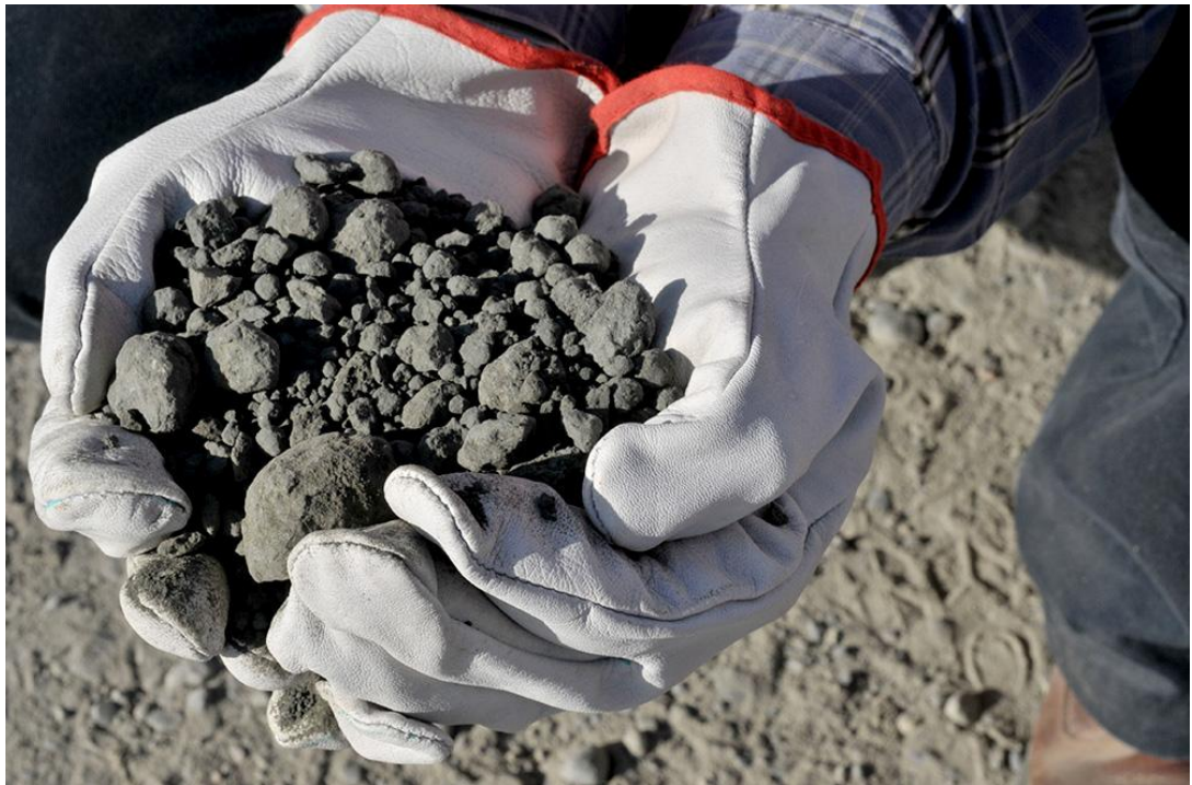
Figura 2.7.1. Clinker, utilizado junto con otros ingredientes en la fabricación del Cemento Portland.
