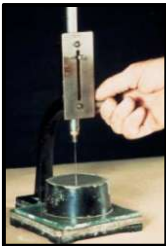
Figura 2.7 Ensayo del tiempo de fraguado en pasta usando la aguja de Vicat (ASTM C-191).
