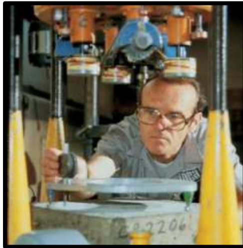
Figura 2.28 Aparato para medir la resistencia a abrasión del concreto (ASTM C-779).
