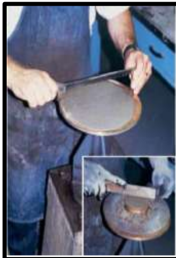
Figura 2.6 Ensayo de consistencia para morteros usando la mesa de fluidez (ASTM C-230).
