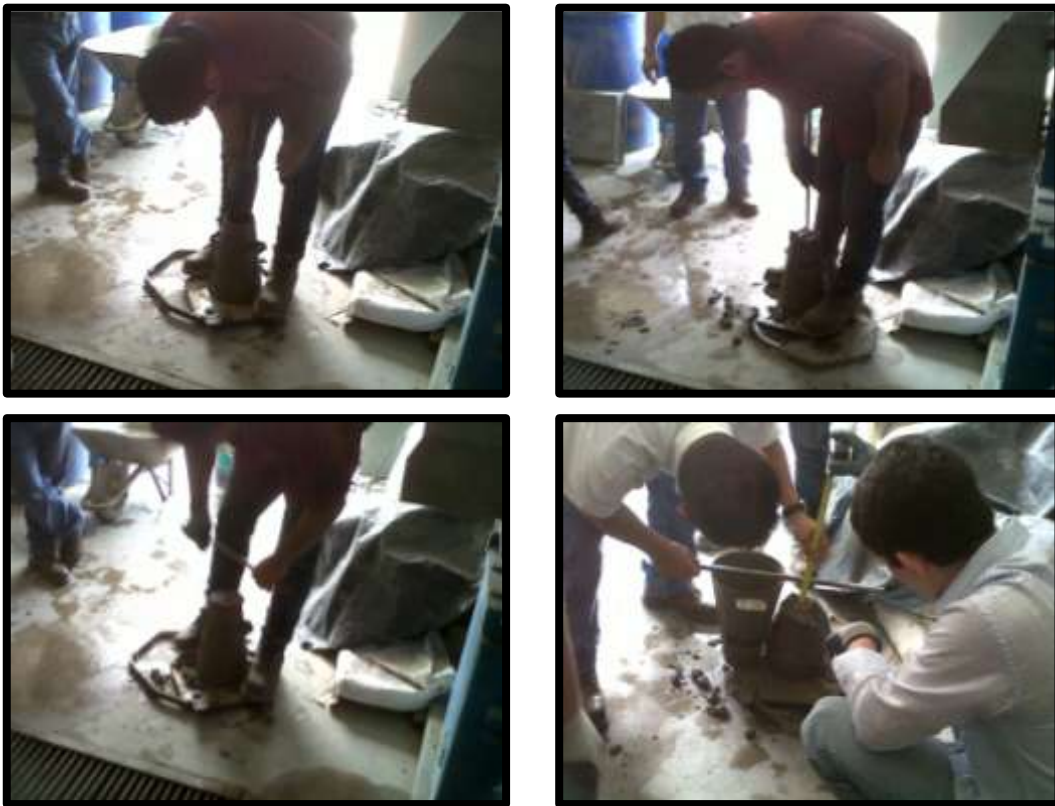
Figura 4.1 Ensayo de revenimiento en mezcla de concreto hidráulico.
