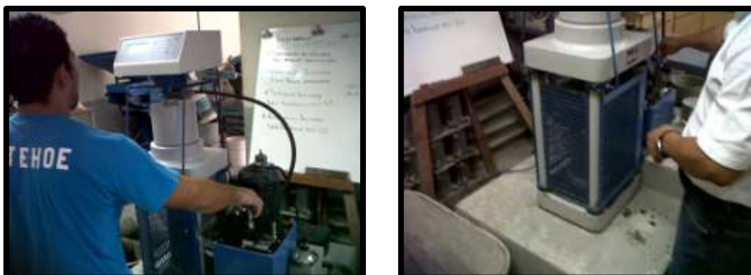
Figura 4.5 Ensayo a compresión de especímenes de concreto hidráulico.
