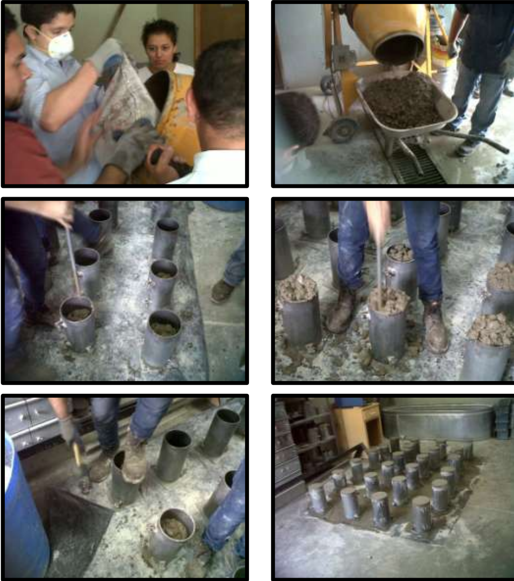
Figura 4.4 Secuencia de elaboración de especímenes de concreto hidráulico.
