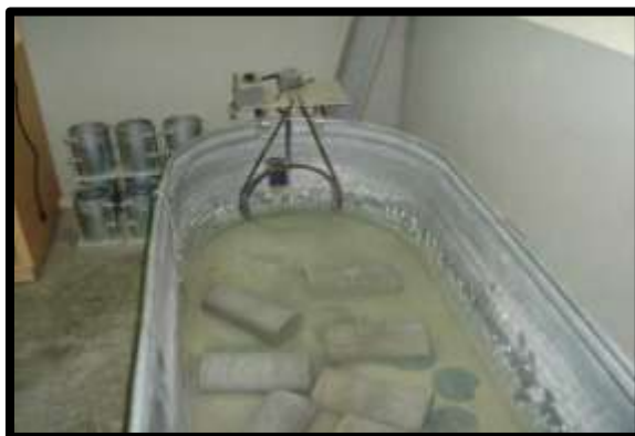
Figura 2.25 Curado de especímenes de concreto.
