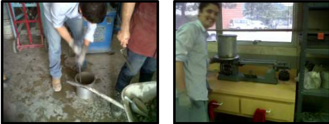
Figura 4.3 Ensayo de peso unitario en mezcla de concreto hidráulico.
