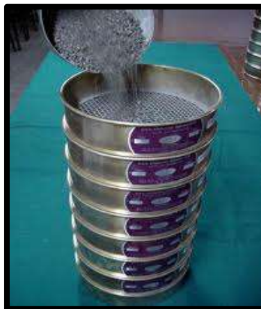
Figura 2.14 Análisis granulométrico de agregados ASTM C-136.
