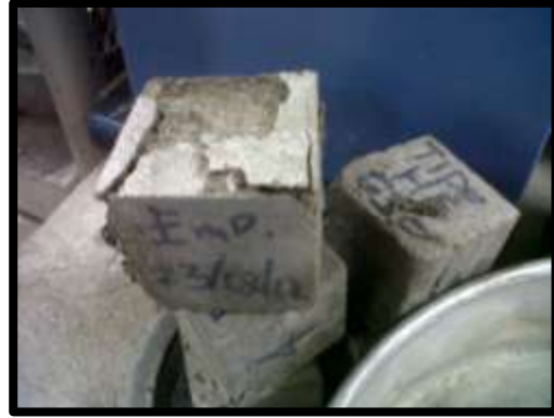
Figura 4.7 Cubos de mortero hidráulico sometidos a ensayo de compresión.
