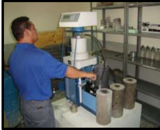
Figura 2.27 Ensayo a compresión del concreto en cilindros de 150x300mm.
