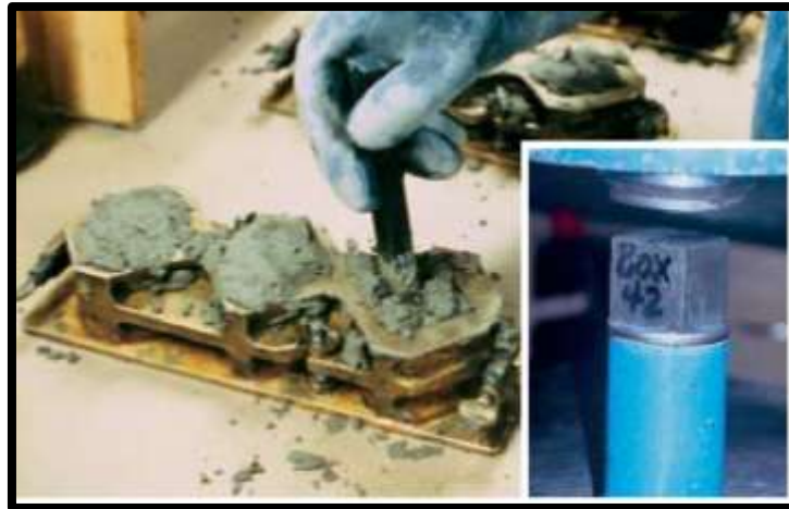
Figura 2.10 Elaboración y ensayo a la compresión de cubos de dos pulgadas ASTM C-109.
