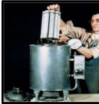
Figura 2.5 Ensayo de sanidad ó expansión en Autoclave (ASTM C-151).
