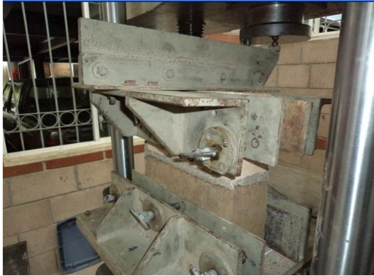
*Figura 6.1: prisma centrado en maquina universal.*
