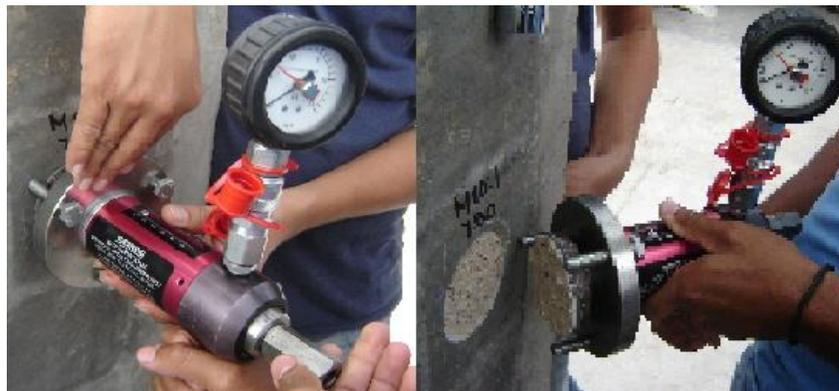
*Figura 5.16: Equipo utilizado en la prueba de adherencia Pull Off, Desprendimiento de capa de mortero adherida al ladrillo de suelo-cemento.*
