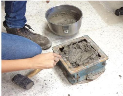
Figura 5.8: Ensayo de tiempo de fraguado
