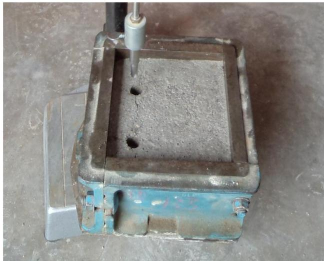
*Figura 3.11: muestra de mortero para tiempo de fraguado.*
