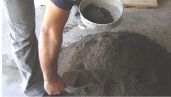
*Figura 4.1: tamizado de agregado*
