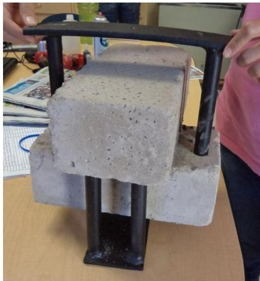
*Figura 6.10 Prisma de ladrillos cruzados*
