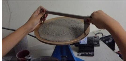
*Figura 5.14 medición de diámetros en diversas direcciones.*
