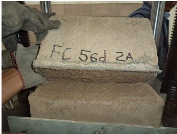
Figura 6.2. Falla por cohesión del ladrillo.
