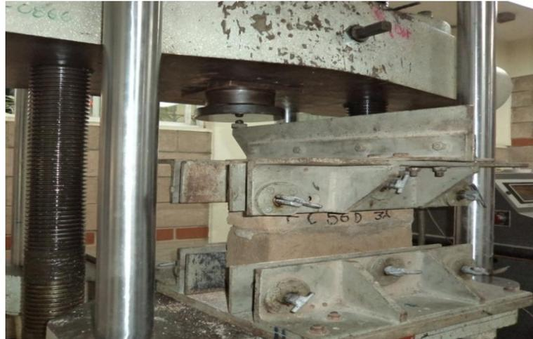
*Figura 3.14. Sujeción de prisma para prueba.*
