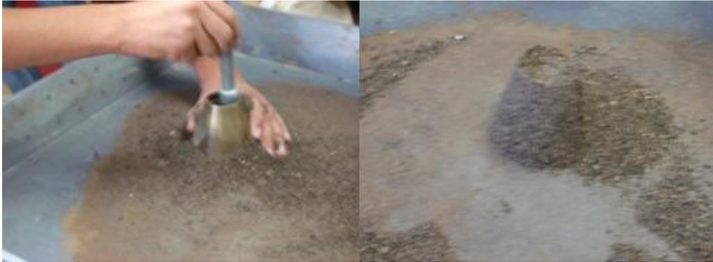
*Figura 4.5 Prueba del cono para verificar la condición SSS.*
