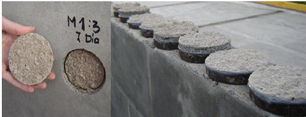
*Figura 5.17: Resultado de ensayo Pull Off.*
