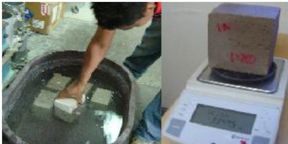
*Figura: 3.3 ensayo de absorción de ladrillos de suelo-cemento; (a) introducción en piscina; (b) saturación de muestras; (c) pesado.*
