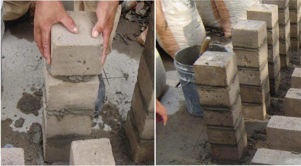
*Figura 3.18: Primas para ensayo de Adherencia por Flexión.*
