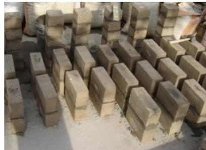
b) Prismas de flexo compresión y compresión simple
