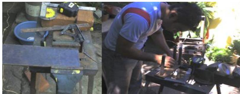
*Figura 3.17 Fabricación Equipo Para Ensayar Los Prismas De Ladrillos Cruzados*
