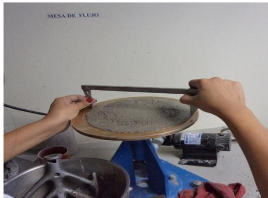
*Figura 5.7: Ensayo de flujo de mortero*
