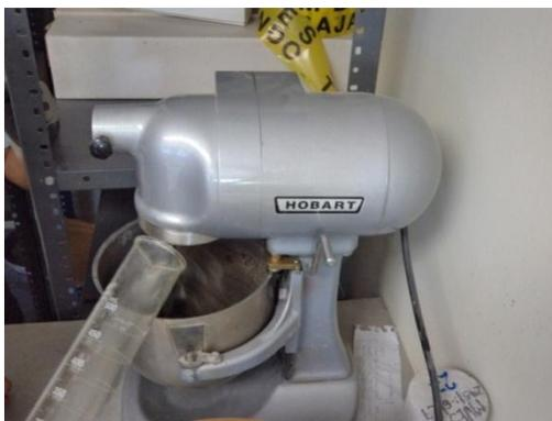
*Figura 4.7: Mezcla mecánica de mortero de cemento.*
