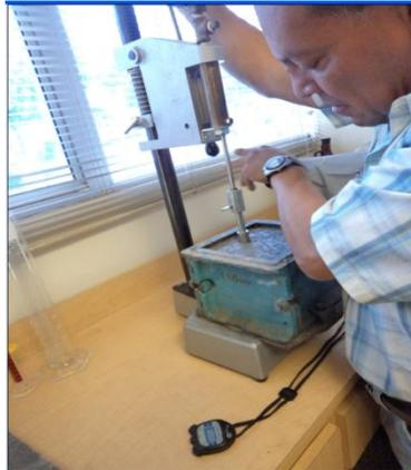
Figura 5.5, Penetración al mortero.
