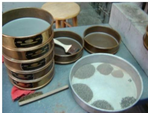
*Figura 4.3: agregado tamizado*
