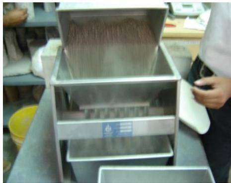
*Figura 4.2: determinación de la muestra a través de cuarteo*
