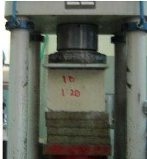
*Figura 3.4: compresión de espécimen de ladrillos de suelo-cemento.*
