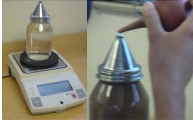
*Figura 4.6: Peso de picnómetro con agua y picnómetro lleno hasta la marca de aforo.*
