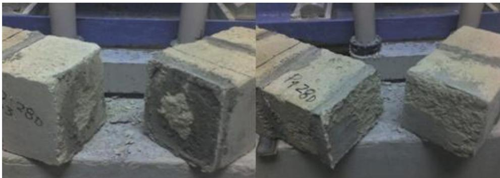
*Figura6.15: Fallas presentadas en prismas sometidos a adherencia por flexión.*
