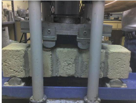
*Figura6.14: Ensayo de adherencia por flexión.*
