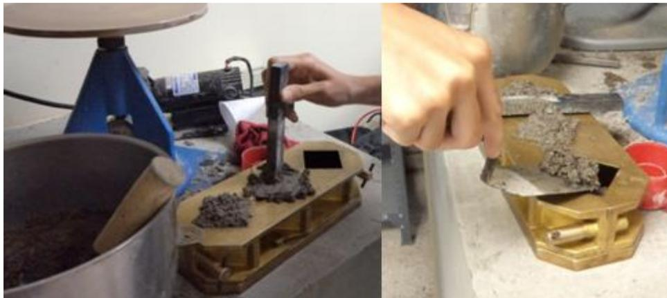
*Figura 4.8 Moldeado y enrasado de cubos de mortero.*
