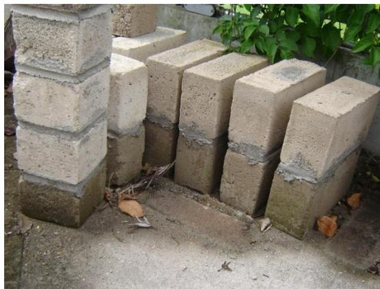
*Figura 3.12. Almacenado y curado de prismas.*
