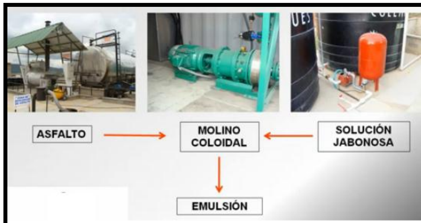
Figura 2.3: Proceso de Fabricación de Emulsión Asfáltica.
