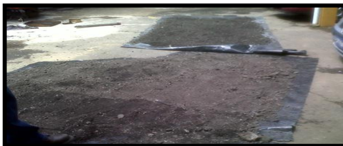
Figura 4.8: Secado de material RAP a temperatura ambiente
