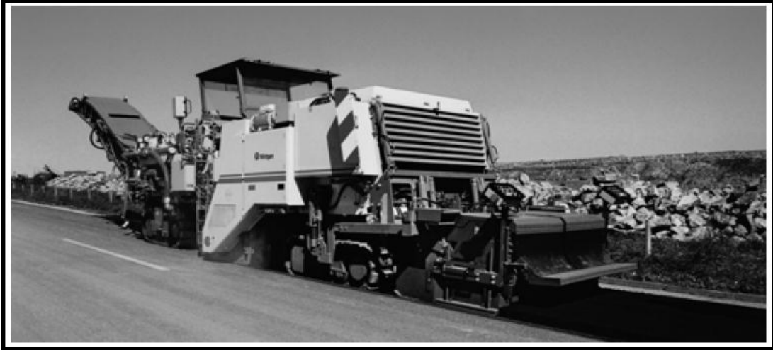
Figura 3.8: Recicladora Wirtgen 2200 CR
