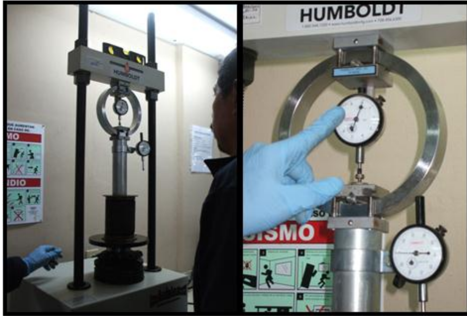
Figura 5.7: Equipo utilizado para ensayo a la Compresión No Confinada
