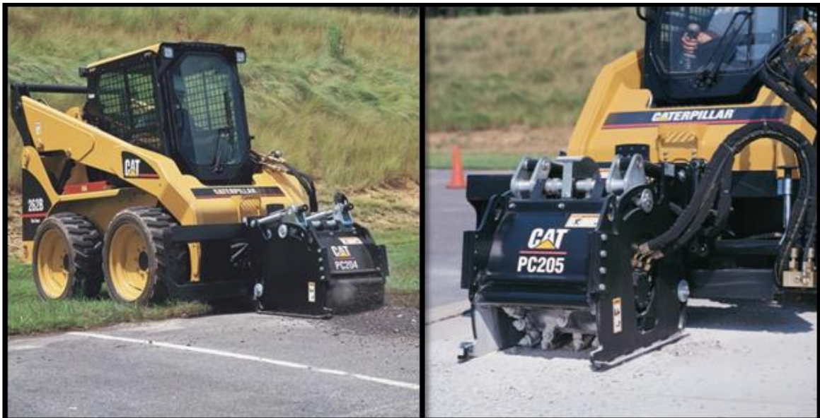
Figura 3.15: Minicargador con fresadora desmontable instalada
