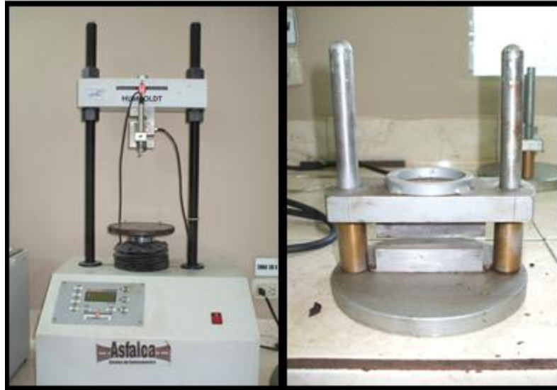
Figura 5.1: Equipo utilizado para realizar prueba de laboratorio TSR
