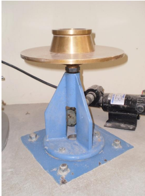
Fotografía No. 19 Mesa de flujo motorizada. Fuente: Grupo de tesis.
