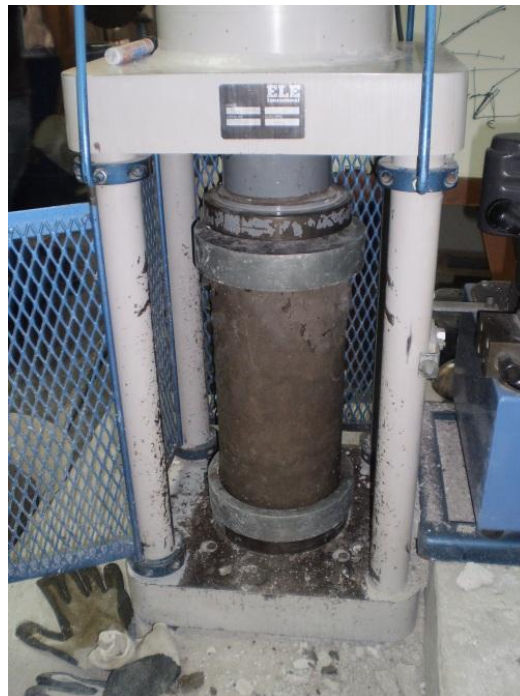
Fotografía No. 35 Especimen sometido a esfuerzo de compresión. Fuente: Grupo de tesis.
