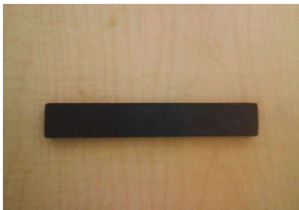
Fotografía No. 20 Apisonador de goma dura, dimensiones de \frac{1}{2} x 1x6 pulg. Fuente: Grupo de tesis.
