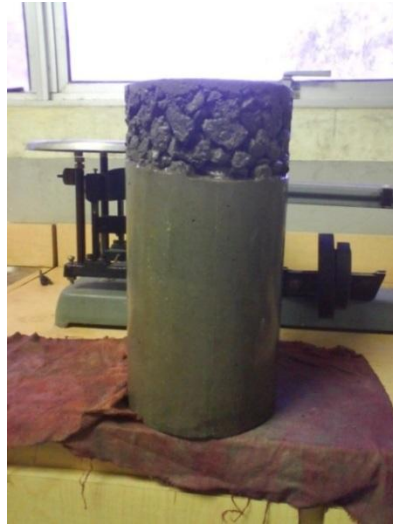
Fotografía No. 36 Espécimen de concreto con formación de colmenas en la tercera capa de colado. Fuente: Grupo de tesis.
