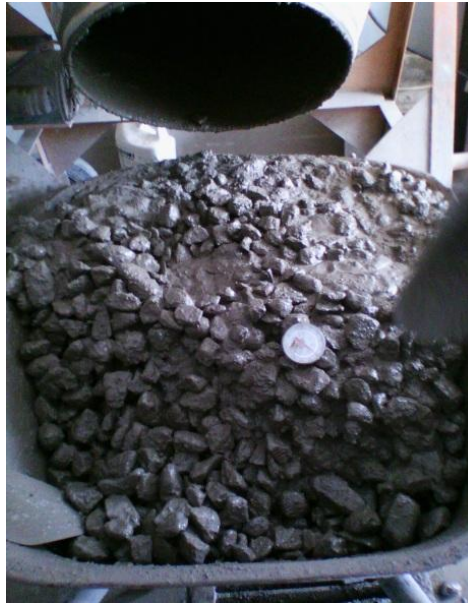
Fotografía No. 28 Medición de la temperatura del concreto fresco. Fuente: Grupo de tesis.
