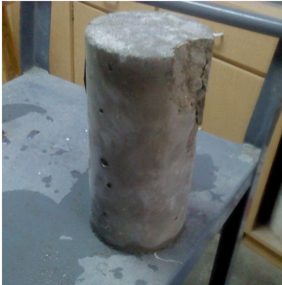
Fotografía No. 38 Espécimen con falla Tipo 5. Fuente: Grupo de tesis.
