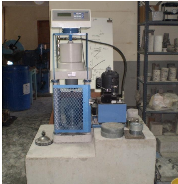
Fotografía No. 1 Máquina de Carga para ensayos de resistencia a compresión. Fuente: Grupo de tesis.
