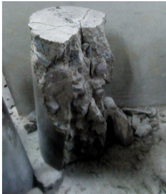
Fotografía No. 39 Espécimen con falla Tipo 3. Fuente: Grupo de tesis.
