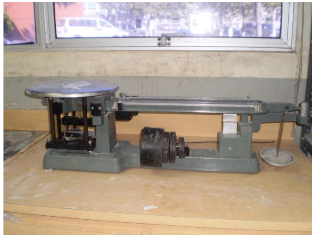
Fotografía No. 4 Balanza análoga para agregado grueso. Fuente: Grupo de tesis.
