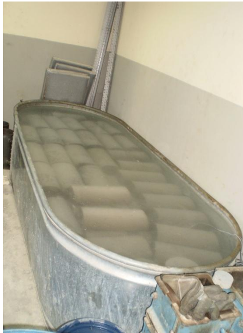
Fotografía No. 32 Tanque de curado. Fuente: Grupo de tesis.
