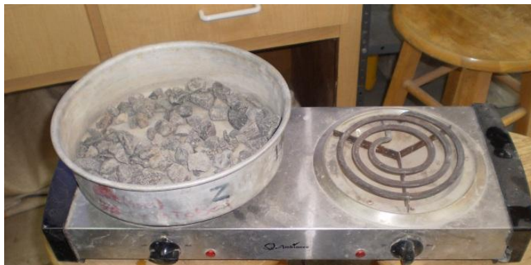
Fotografía No. 16 Cocina eléctrica para el secado del agregado grueso. Fuente: Grupo de tesis.
