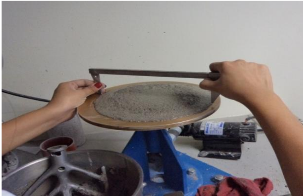
Fotografía No. 21 Toma de lectura de los diámetros del mortero. Fuente: Grupo de tesis.
