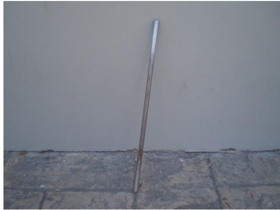
Fotografía No. 12 Varilla compactadora de 5/8 pulg de diámetro. Fuente: Grupo de tesis.
