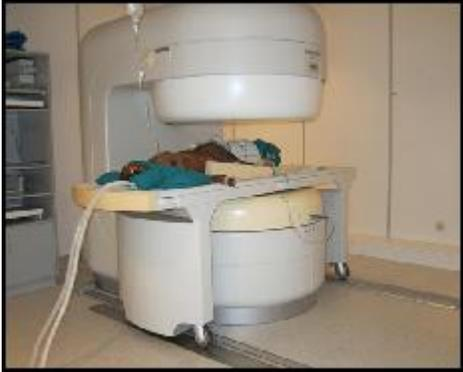
Los imanes resistivos producen un campo magnético al paso de la corriente eléctrica por un bobinado. A diferencia de los súper conductores, el equipo tiene que estar conectado a la corriente eléctrica durante su funcionamiento, cuando se desconecta el campo desaparece. Su diseño es más sencillo que el de los súper conductores, no
