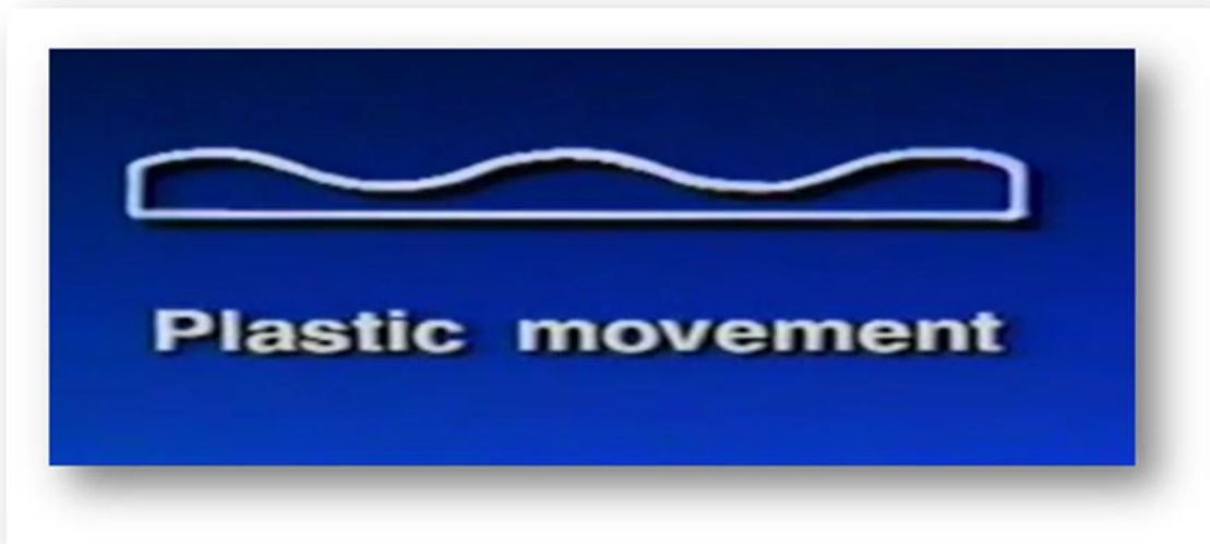
FIGURA 1.4: Ahuellamiento causado por movimiento plástico
