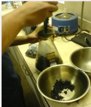
IMAGEN 4.17: Proceso de introducción de la muestra en el picnómetro.
