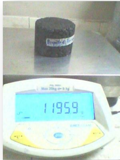
IMAGEN 4.8: Toma de pesos de briquetas en balanza electrónica.
