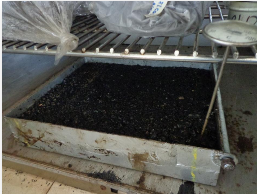
IMAGEN 4.37: Curado de la mezcla asfáltica.
