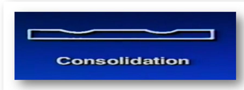
FIGURA 1.5: Comportamiento del ahuellamiento generado por consolidación.
