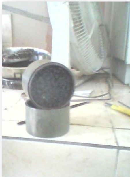
IMAGEN 4.6: Briqueta recién compactada en martillo Marshall.
