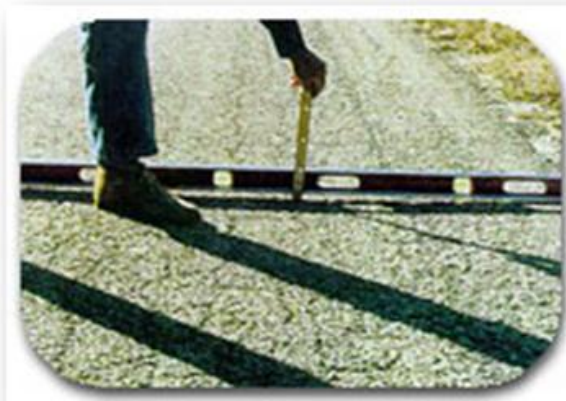
FIGURA 1.5: Comportamiento del ahuellamiento generado por consolidación.
