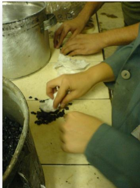
IMAGEN 4.22: Procedimiento de secado superficial del agregado
