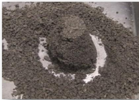
IMAGEN 4.25: Cono truncado formado de agregado fino, que demuestra la condición saturado superficialmente seco del mismo.
