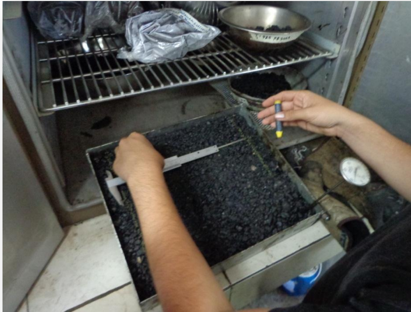
IMAGEN 4.38: Marcado de la briqueta en los puntos donde se mide el ahuellamiento.
