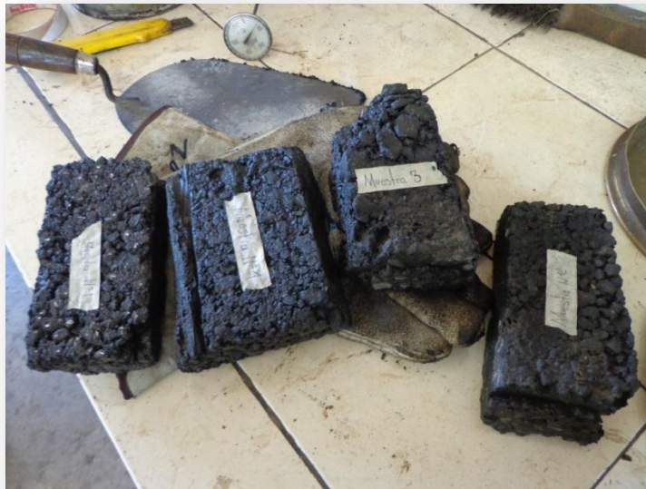
IMAGEN 4.43: separación de briquetas para llevar a cabo prueba Bulk.
