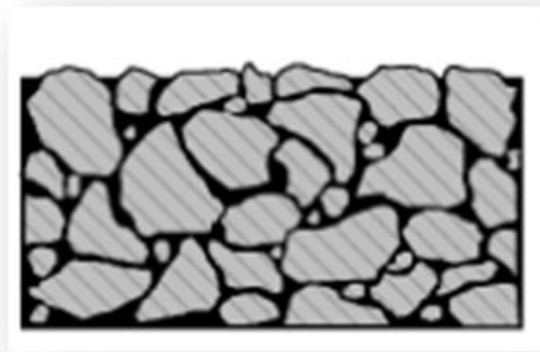
FIGURA 3.2: sección típica de una mezcla con gradación discontinua. 40
