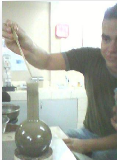
IMAGEN 4.29: Aforado del picnómetro, conteniendo la muestra de ensayo.
