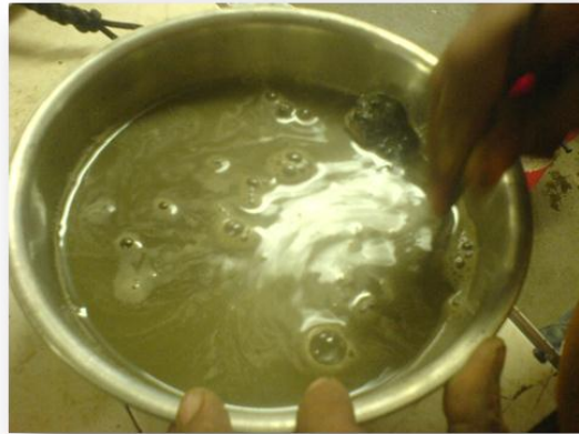
IMAGEN 4.23: Muestra de agregado fino a dejar en reposo por 24 hr
