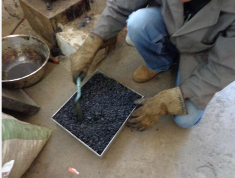
IMAGEN 4.34: colocación de mezcla asfáltica dentro del molde
