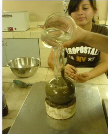
IMAGEN 4.27: Llenado del picnómetro con muestra y agua
