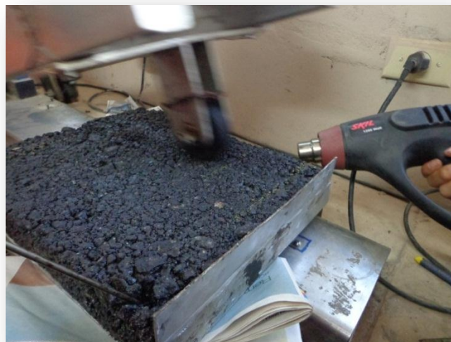
IMAGEN 4.40: Aplicación de calor a la briqueta por medio de pistola de calor.
