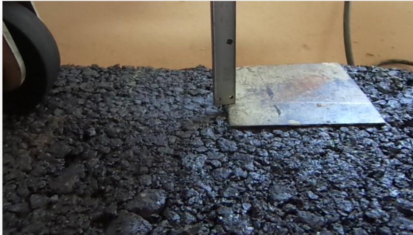
IMAGEN 4.42: proceso de medición del ahuellamiento en diversos puntos
