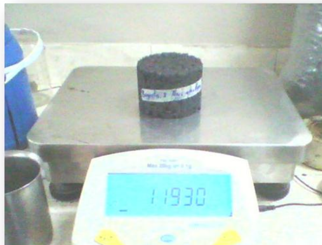
IMAGEN 4.11: Pesaje de las briquetas en estado SSS en balanza electrónica.
