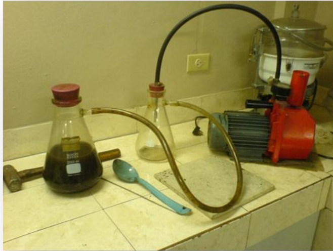
IMAGEN 4.19: sistema de bombeo para la extracción de vacíos.
