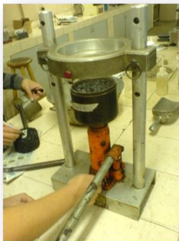
IMAGEN 4.7: Desenmoldado de briquetas en el gato hidráulico.
