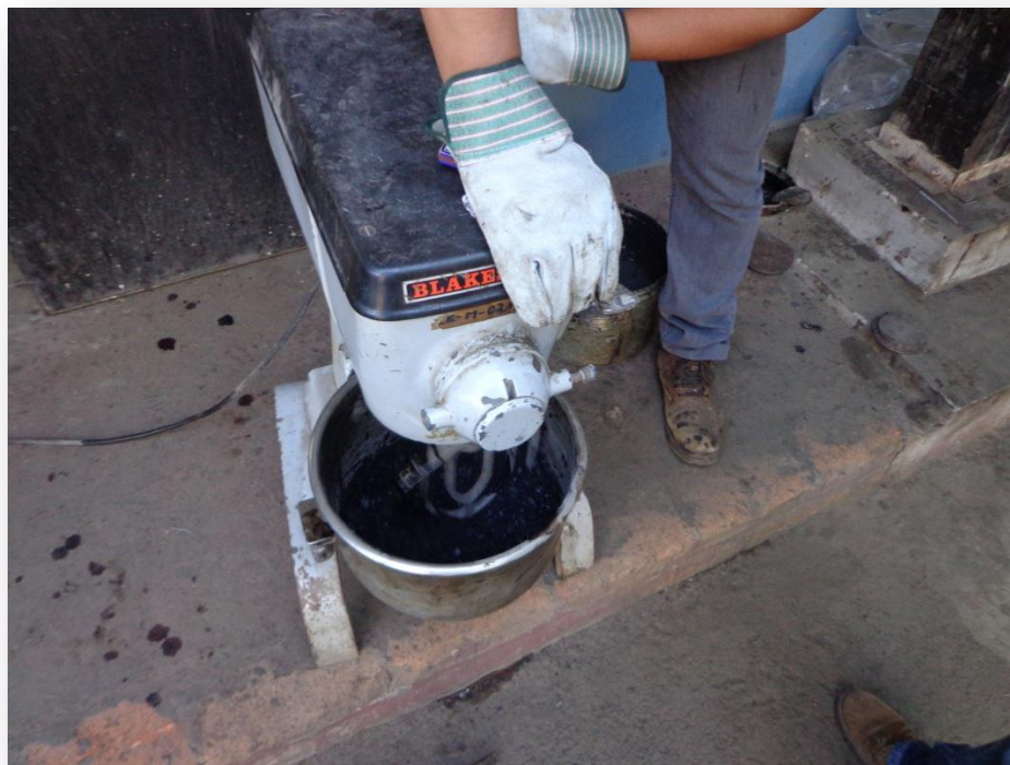
IMAGEN 4.32: proceso de mezclado de agregados y cemento asfáltico mediante una máquina mezcladora.
