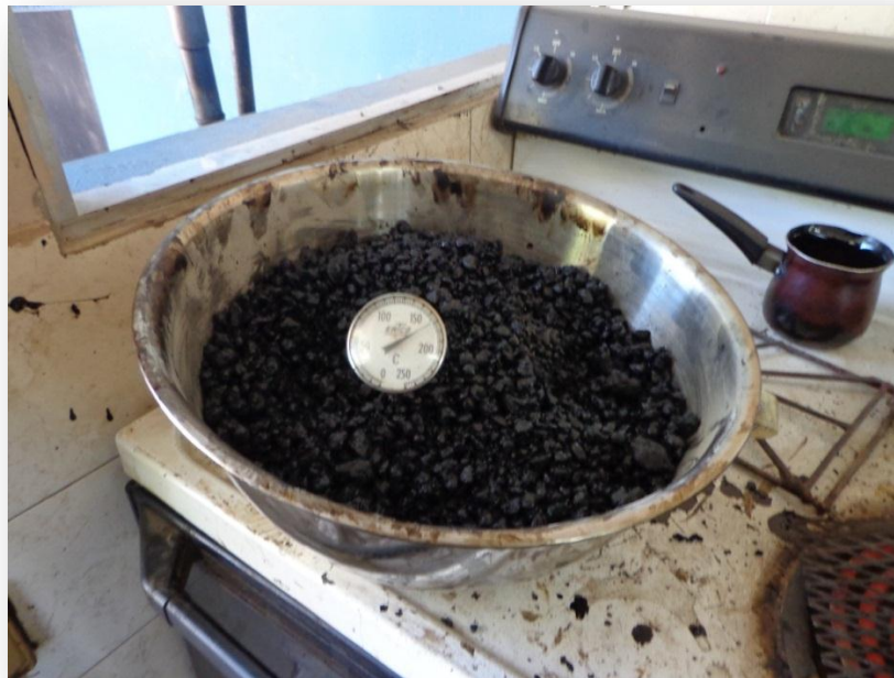
IMAGEN 4.33: Bachada de mezcla asfáltica a ser compactada.
