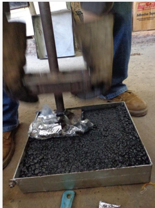
IMAGEN 4.36: Proceso de compactación de la briqueta
