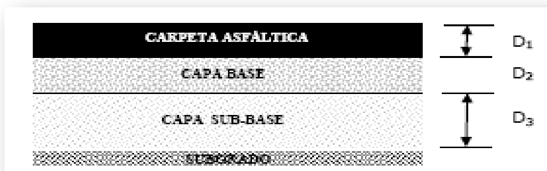
FIGURA 4.12: Estructura esquemática de pavimento flexible.
