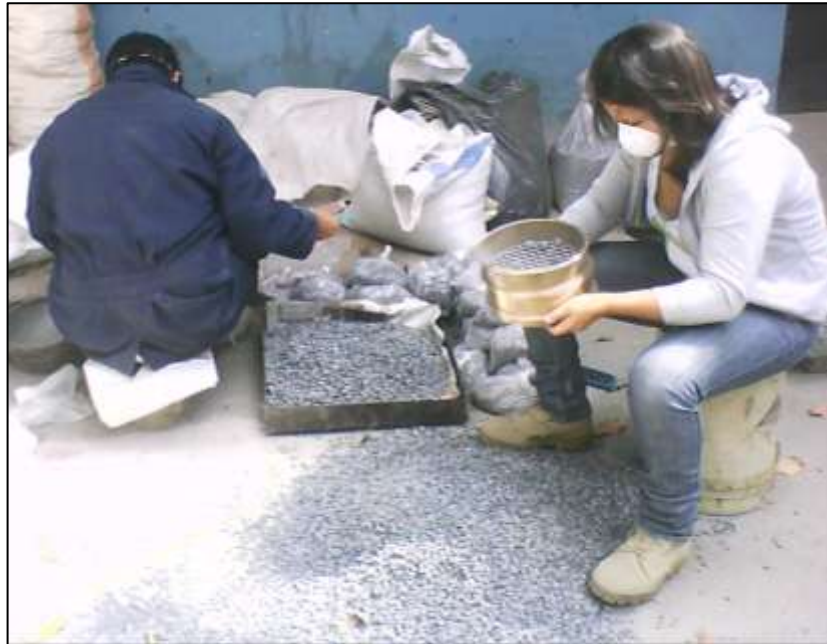
Figura 3.20 Tamizado de los agregados pétreos para conseguir la granulometría T-10
