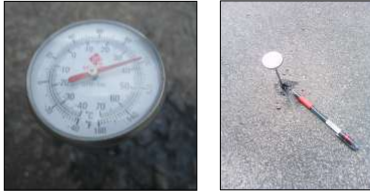
Figura 3.8. Muestra la colocación del termómetro de espiga en el agujero y la forma en la cual se toman los datos de temperatura
