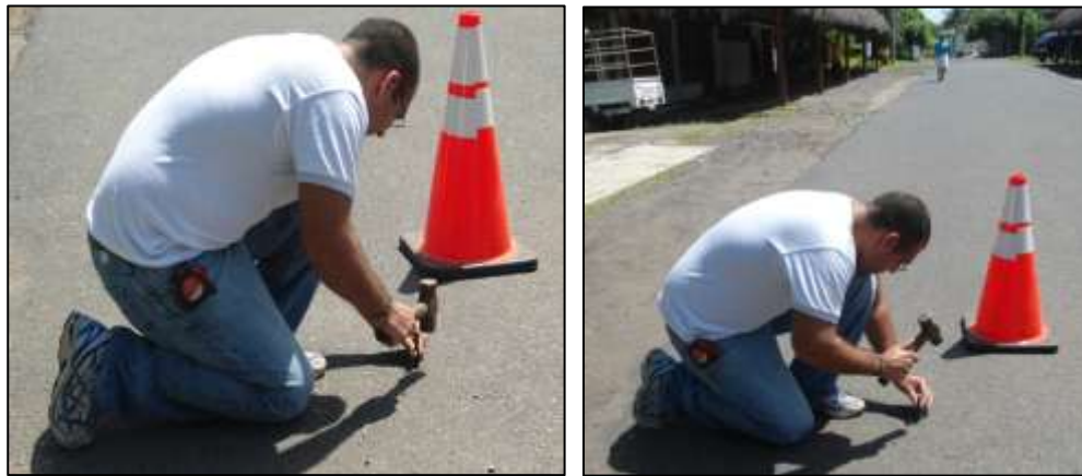
Figura 3.5. Zona de medición carretera a Acajutla departamento de Sonsanote. Integrante del grupo de investigación iniciando la etapa de perforación de agujeros sobre la carretera.
