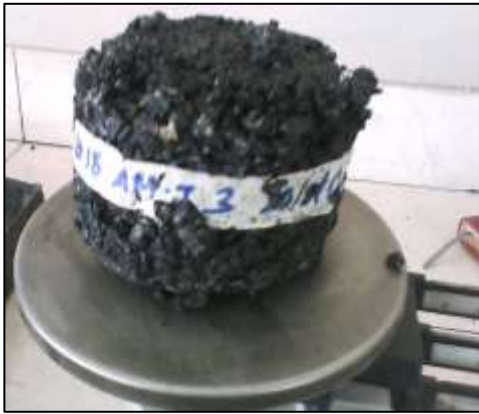
a) Briqueta sometida a 100 revoluciones
