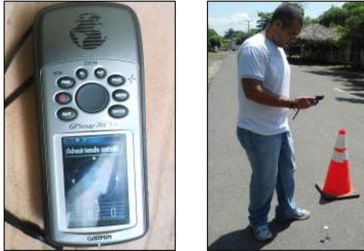
Figura 3.7. Zona de medición carretera de Metapán departamento de Santa Ana. Integrante del grupo de investigación tomando los datos de coordenadas geográficas del punto donde se tomara la temperatura del pavimento.
