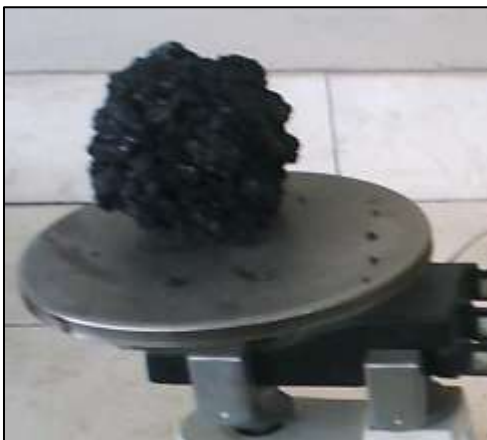
c) Briqueta sometida a 300 revoluciones
