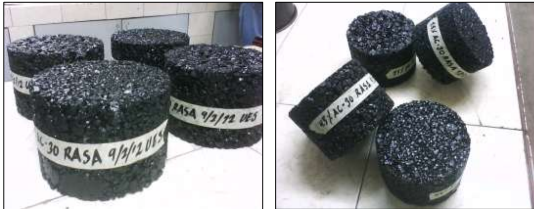
Figura 3.27 Briquetas fabricadas del tipo de asfalto AC-30 ya desmoldadas y etiquetadas.
