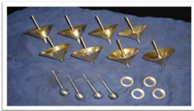
Figura 3.15 Equipo para la determinación del punto de ablandamiento (ASTM D36). La imagen muestra algunos de los instrumentos utilizados para la realización del ensayo.
