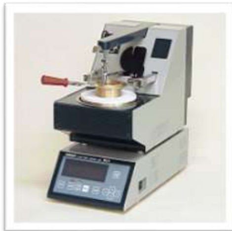
Figura 3.18 Equipo para determinación de punto de inflamación según cleveland copa abierta (ASTM D92)
