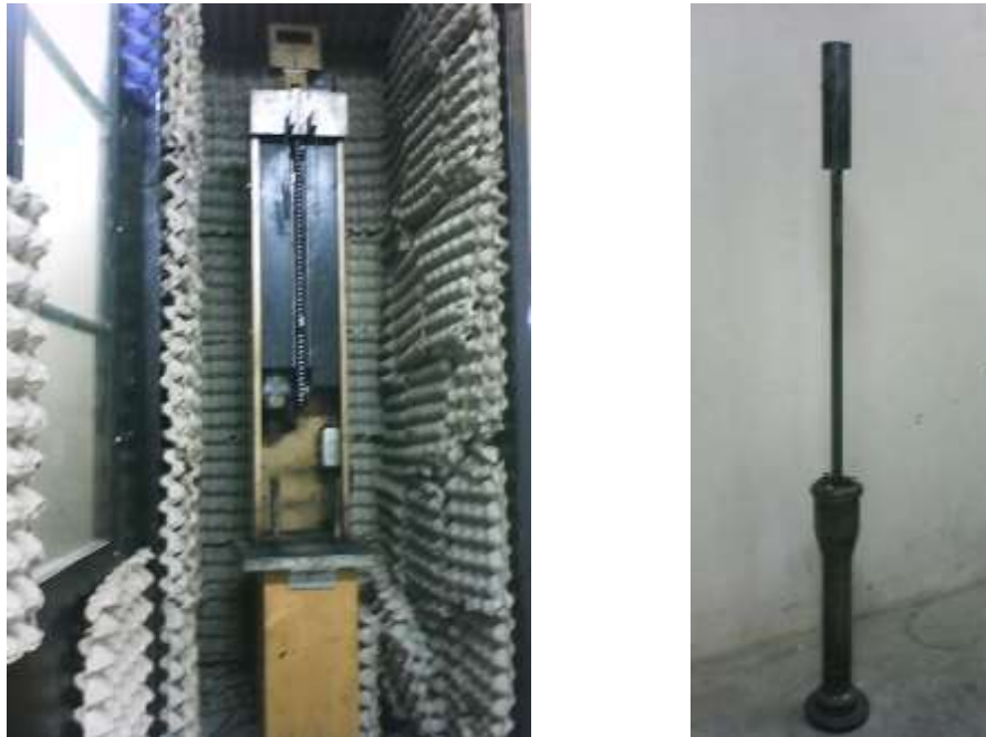
Figura 3.22 Martillo mecánico normalizado, la figura de la izquierda muestra la maquina que hace funcionar al martillo que se muestra en la figura de la derecha.
