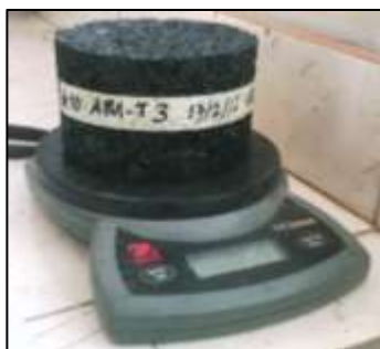
Figura 3.29 briketa siendo pesada en vascula digital antes de ser sometida al ensayo cantabro.
