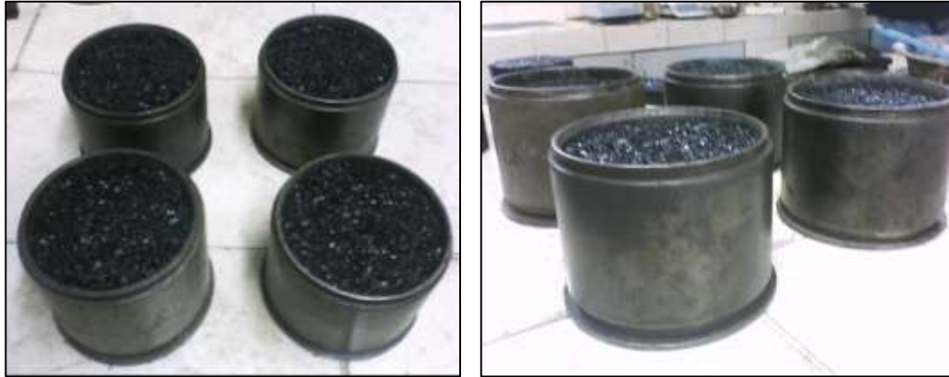
Figura 3.25 Briquetas cilíndricas tipo Marshall en proceso de enfriado después de compactadas.
