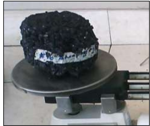
b) Briqueta sometida a 200 revoluciones
