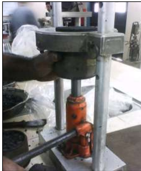
Figura 3.26 Proceso de desmoldado de una briqueta.
