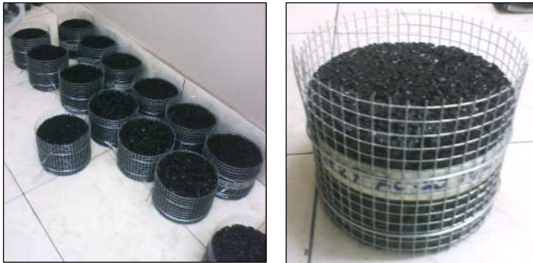
Figura 3.28 Dispositivo estabilizador de briquetas empleado para evitar el desmoronamiento y la pérdida de la forma cilíndrica producto de las altas temperaturas a las que se sometieron.
