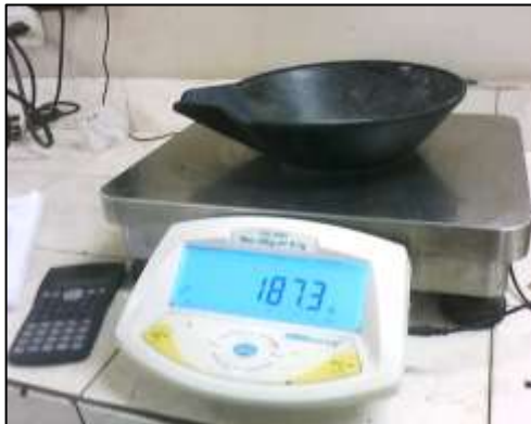
Figura 3.21 muestra la bascula digital empleada para realizar el proceso de mezclado en el momento de pesado de una tara.
