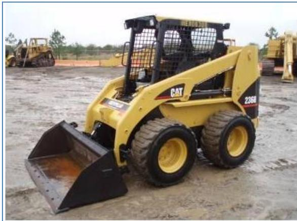
**Figura 5.3.** “Cargador CAT 236, capacidad de carga 1 tonelada”.
