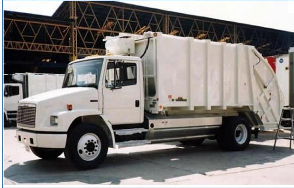
**Figura 5.2.** “Camión compactador, de eje de tracción doble rueda, capacidad de carga 8 toneladas”.
