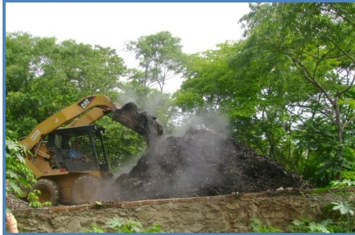
**Figura 2.3** “Volteo en forma mecanizada”.
