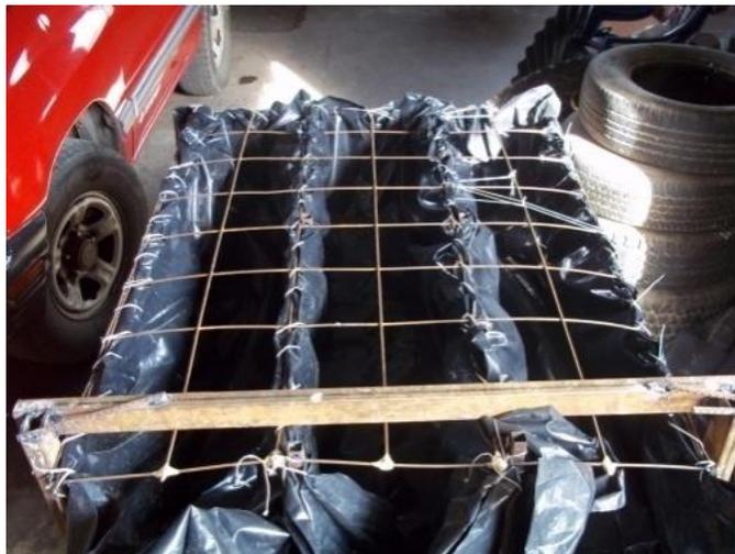
**Figura 5.11 Dispositivo de curado**
