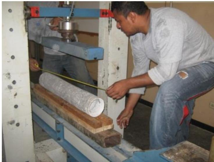
**Figura 8.19 Colocación de tubo**
