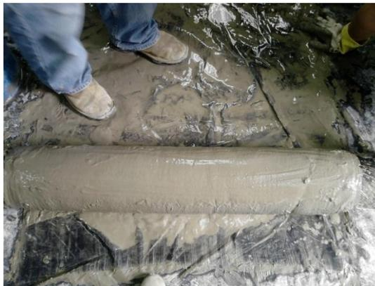
**Figura 5.9 Tubería propuesta en estado fresco.**
