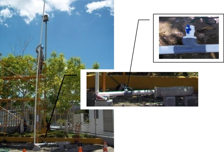
**Figura 8.15 Sistema para aplicación de presión hidrostática en tubos propuestos**
