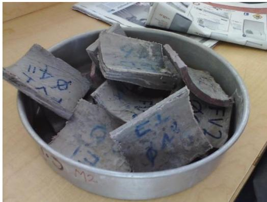
**Figura 8.1 Muestras de tubos para prueba de absorción**
