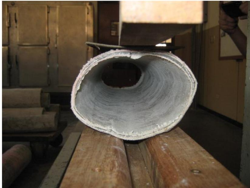
**Figura 8.23 Aplastamiento del tubo ensayado**
