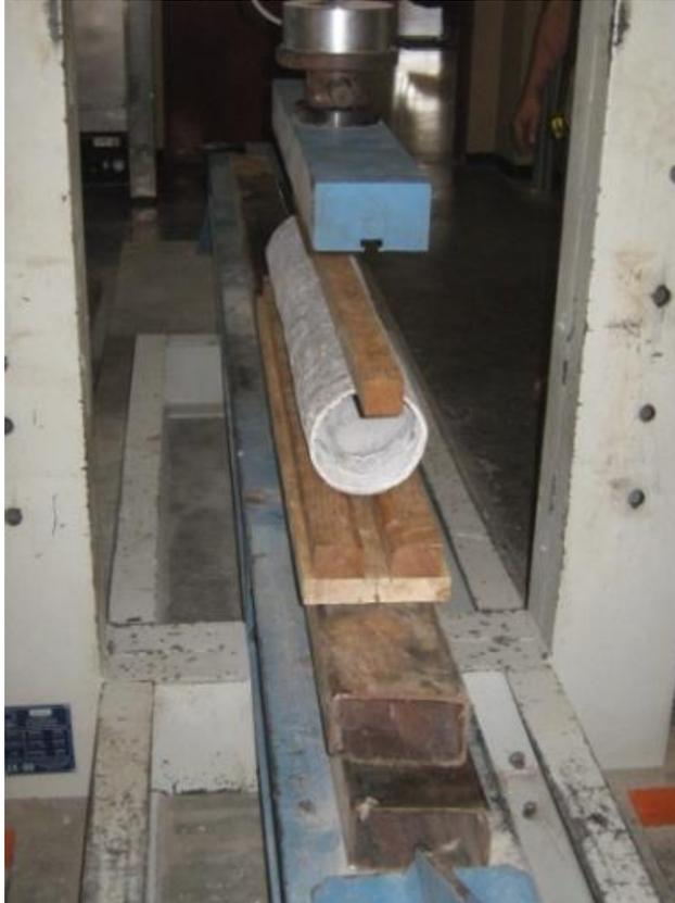
**Figura 8.20 Ensayo de compresión de tubo**
