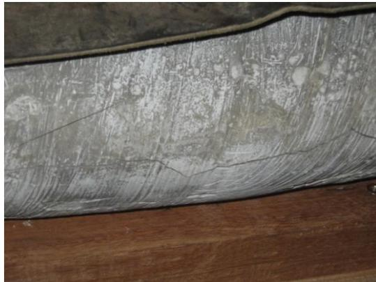
**Figura 8.22 Grieta en tubo ensayado**
