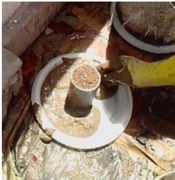
**Figura 8.10 Procedimiento de sellado de tubo**
