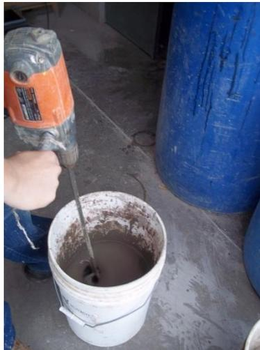
**Figura 5.1 Preparación de la pasta de cemento.**
