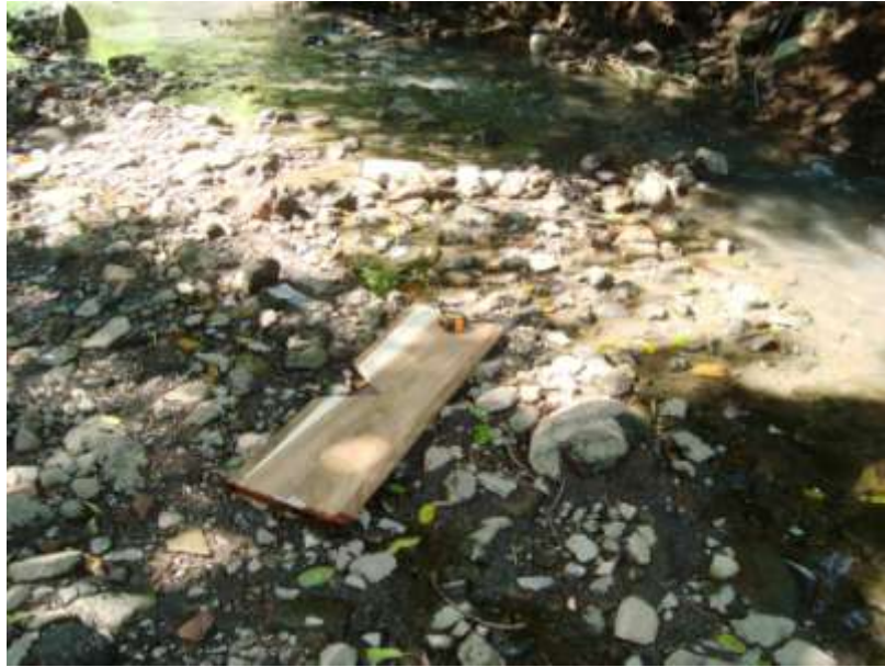
Foto 5. Vertedero triangular utilizado para la obtención del caudal en Rio Apanchacal.
