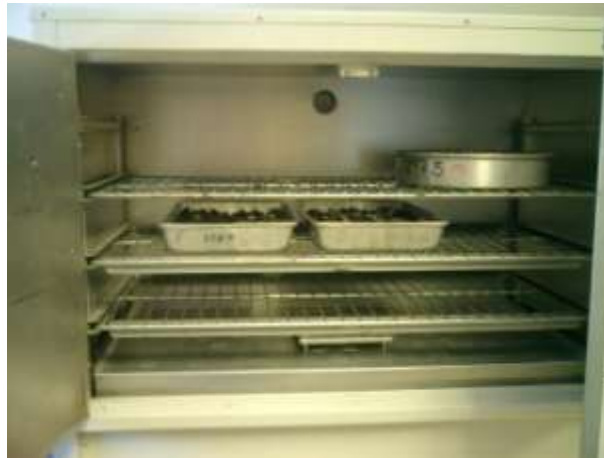
Imagen 3.18 Colocación del agregado grueso en el horno para el secado del material.
