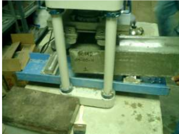
Imagen 3.43. Colocación de vigas para prueba de flexión.
