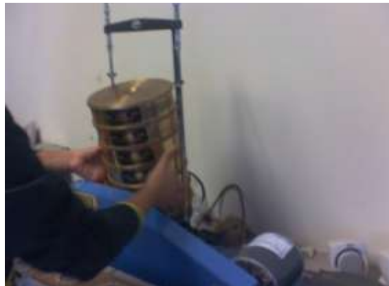
Imagen 3.07 Colocación del juego de mallas en el agitador de mallas motorizado.
