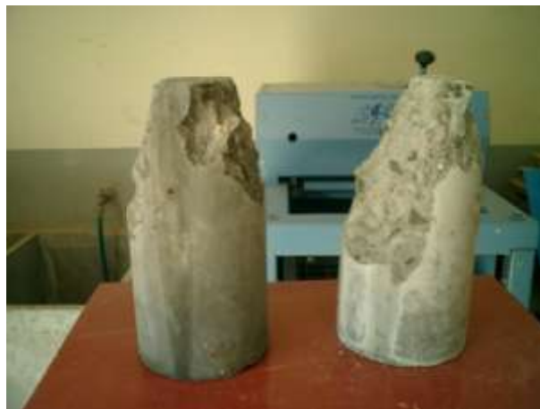
Imagen 3.42 Especímenes ya ensayados, en donde se aprecia el tipo de ruptura registrado.
