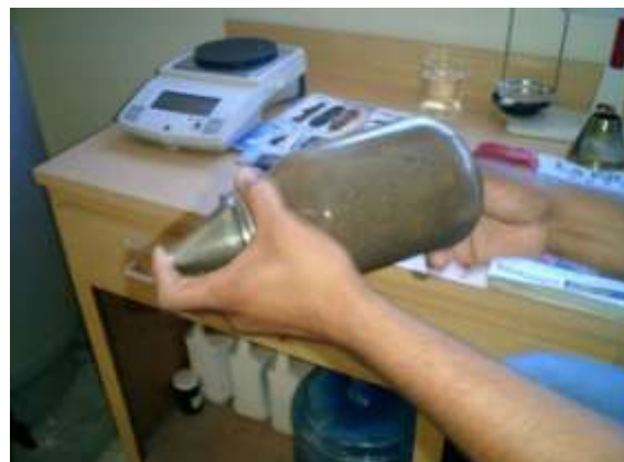
Imagen 3.27. Proceso de agitación del picnómetro con agua y agregado fino.
