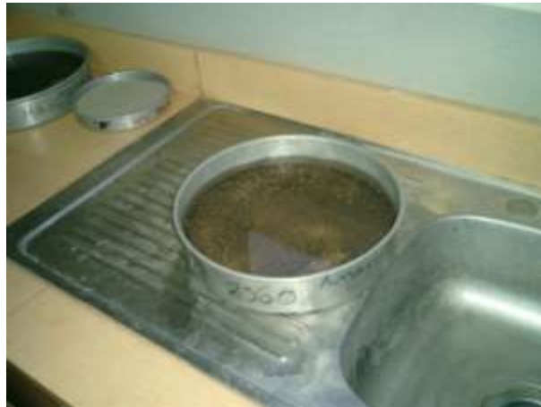
Imagen 3.19 Agregado fino totalmente sumergido en agua.
