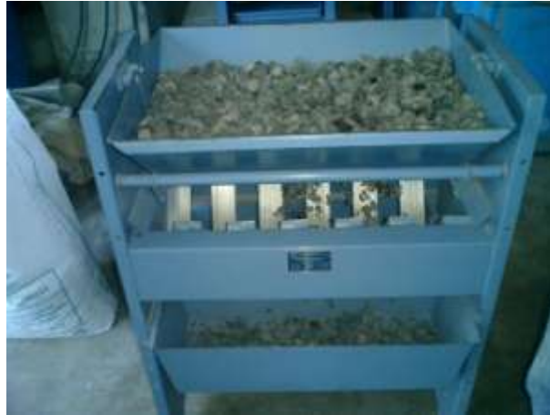
Imagen 3.11 Proceso de cuarteado del agregado grueso.
