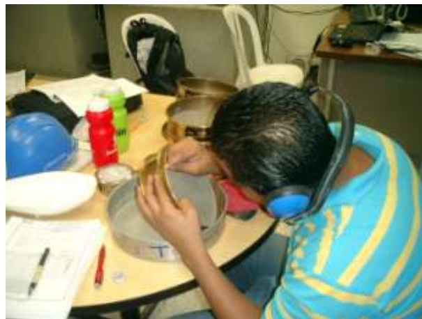
Imagen 3.10 Limpieza de mallas, después del proceso de tamizado.
