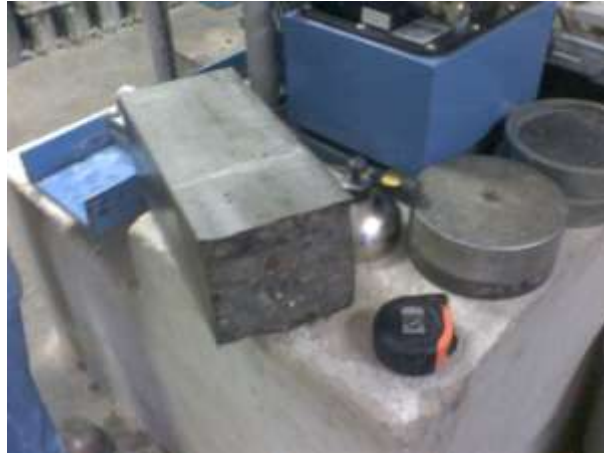
Imagen 3.47 Medición de la sección de falla de la viga.
