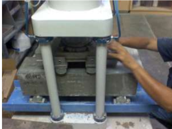
Imagen 3.44 Ajuste y alineación de la máquina para pruebas de flexión.
