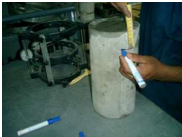
Imagen 3.48 Proceso de marcaje de los cilindros para la colocación del equipo.
