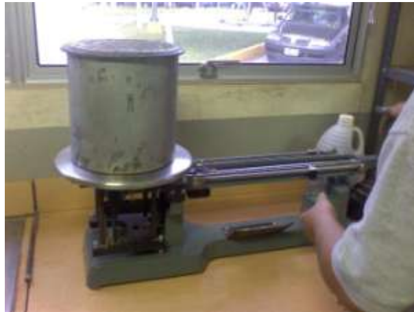
Imagen 3.39 Obtención de la masa del recipiente más concreto.
