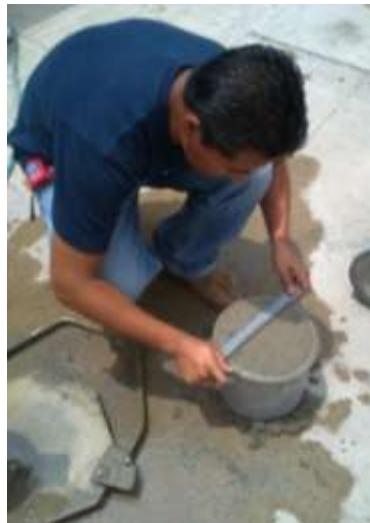
Imagen 3.38 Proceso de enrase del recipiente utilizando la llana metálica.
