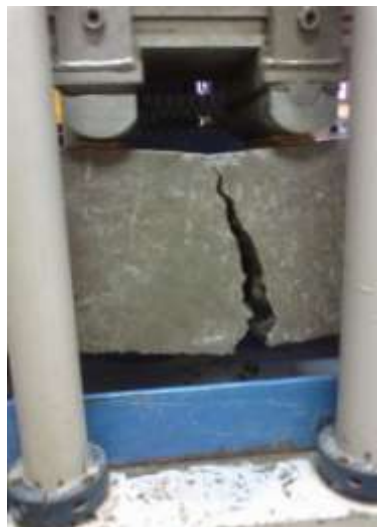
Imagen 3.46 Punto de Ruptura de vigas, prueba de vigas a flexión.
