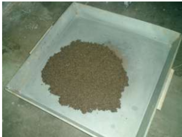
Imagen 3.21 Agregado fino sobre superficie no absorbente.
