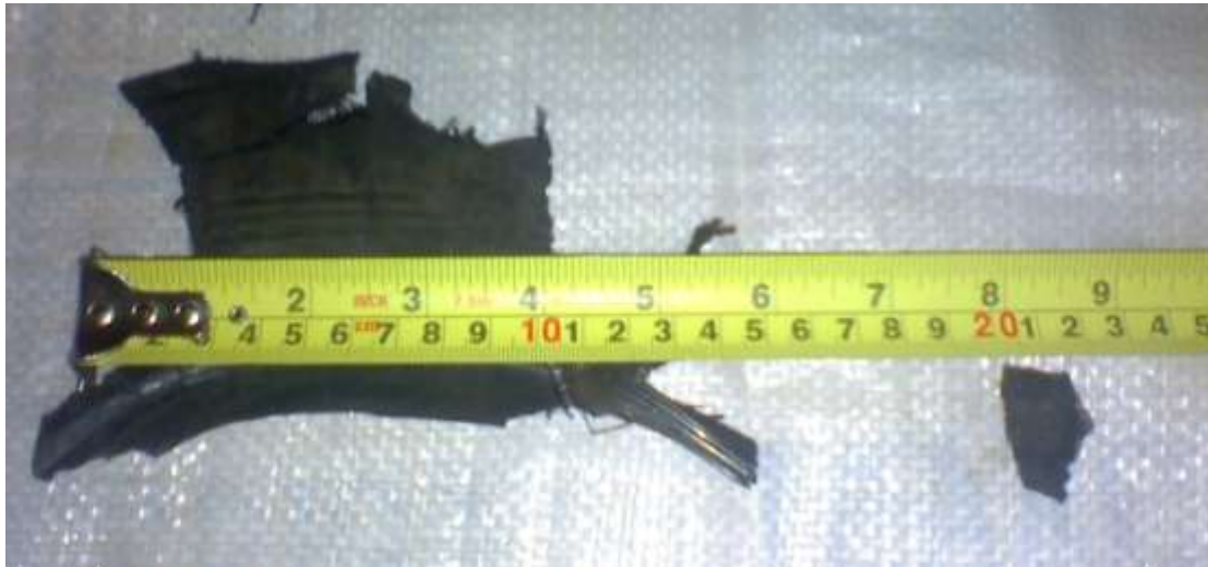
Imagen 4.12 Tamaño comparativo de las partículas de llanta triturada en estado inicial y final.
