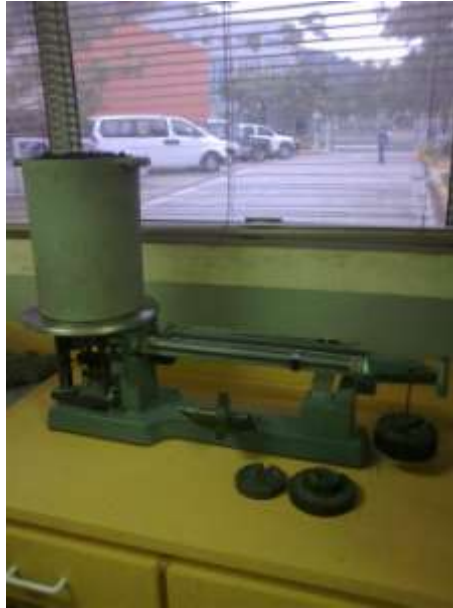
Imagen 3.37 Obtención de la masa del recipiente más agregado grueso sintético.
