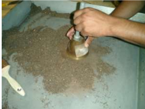
Imagen 3.23 Prueba del cono de absorción para determinar la condición saturado superficialmente seco.
