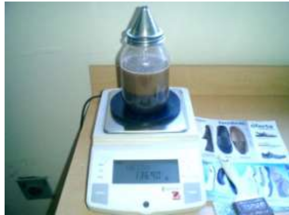
Imagen 3.26 Determinación de la masa del picnómetro más agua más agregado fino.
