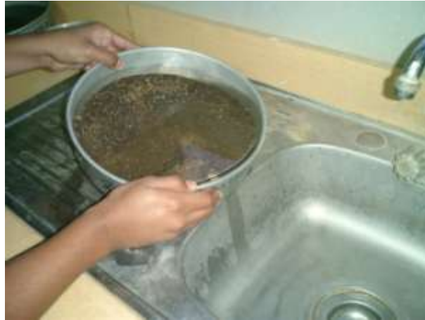
Imagen 3.20 Decantación del recipiente para eliminar excedente de agua.
