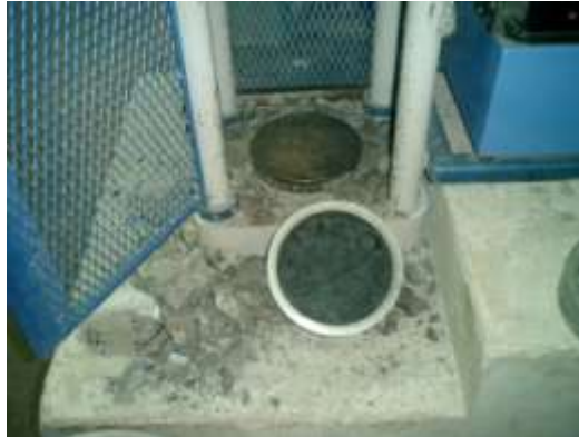
Imagen 3.41 Almohadilla de neopreno y retenedor para ensayo de cilindros de concretos.
