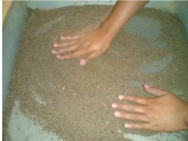
Imagen 3.22 Proceso de esparcir el agregado sobre la superficie no absorbente.
