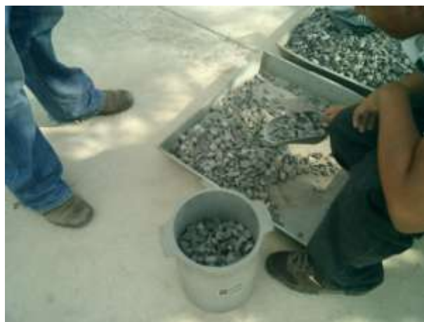
Imagen 3.32 Proceso de llenado del recipiente con agregado grueso.
