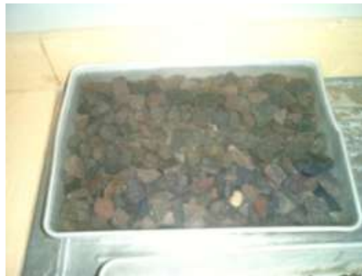
Imagen 3.13 Agregado grueso sumergido totalmente en agua.
