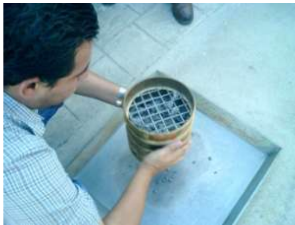
Imagen 3.03 Proceso de Tamizado del agregado grueso.
