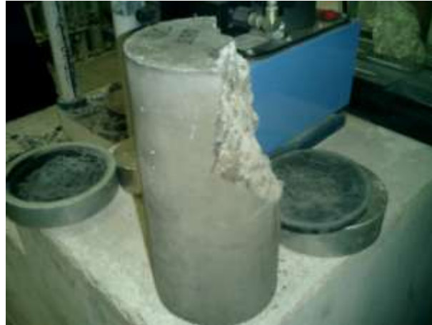
Imagen 3.50 Cilindro llevado hasta el punto de ruptura después de haber realiza las pruebas.
