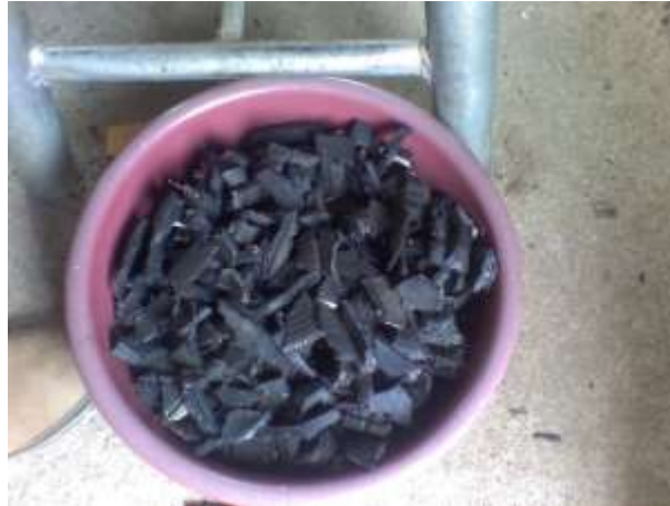
Imagen 4.10 Material final triturado artesanalmente tamaño máximo nominal 3/4 “.
