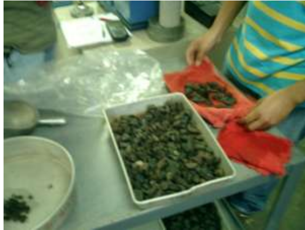
Imagen 3.14 Limpieza del exceso de agua del agregado grueso, utilizando franelas.
