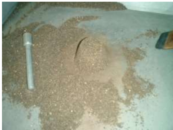
Imagen 3.24 Condición saturada superficialmente seco alcanzada.
