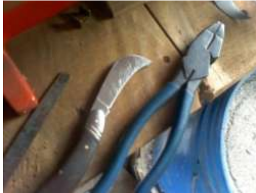
Imagen 4.07 Herramientas a utilizar: lima, cuchilla de electricista y tenaza.
