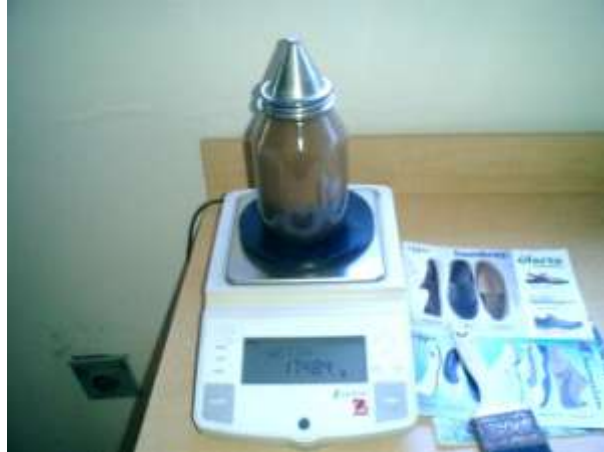
Imagen 3.28 Obtención de la masa del picnómetro, más agua, mas agregado, libre de partículas de aire.
