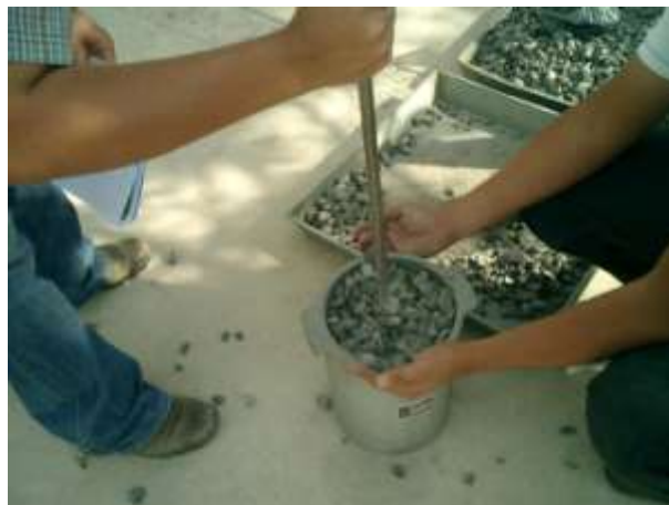
Imagen 3.35 Proceso de varillado de la última capa.
