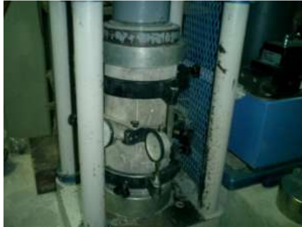
Imagen 3.49 Cilindro colocado sobre la máquina de pruebas de compresión.
