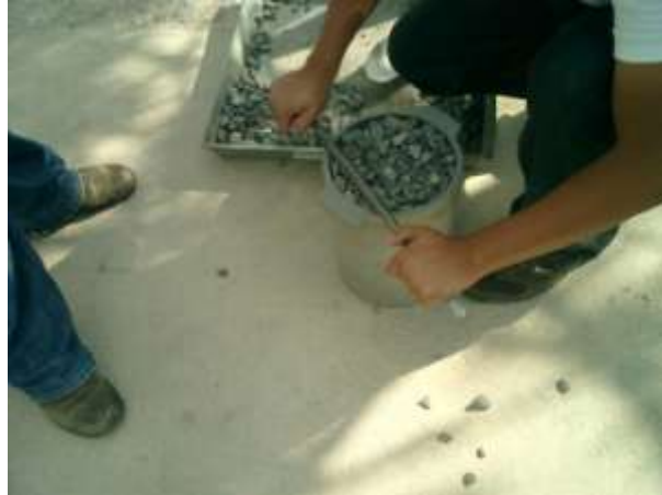
Imagen 3.36 Proceso de enrase del material.
