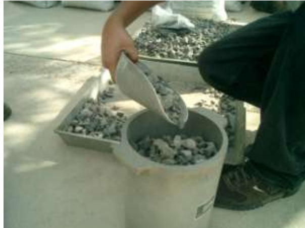
Imagen 3.34 Proceso de llenado del recipiente con agregado grueso.
