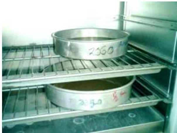
Imagen 3.29 Colocación del material en el horno para su secado total.
