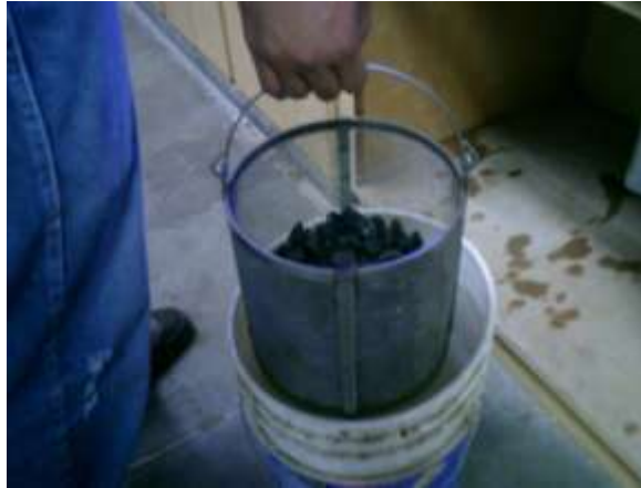
Imagen 3.16 Material grueso colocado en la Cesta de Alambre.
