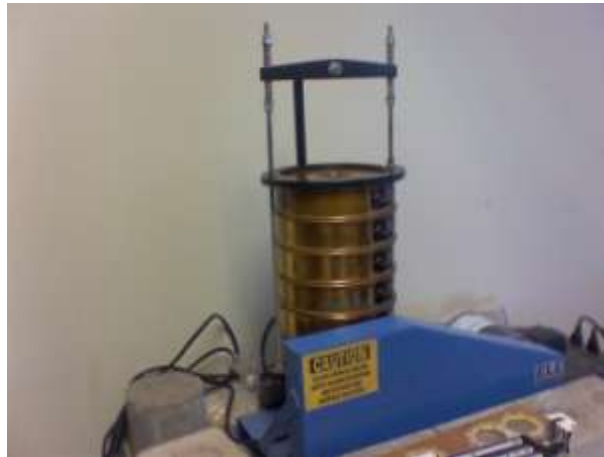
Imagen 3.08 Juego de mallas para agregado fino, instalado sobre el agitador de mallas motorizado.
