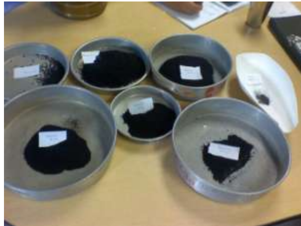
Imagen 3.09 Material sintético fino tamizado y separado.
