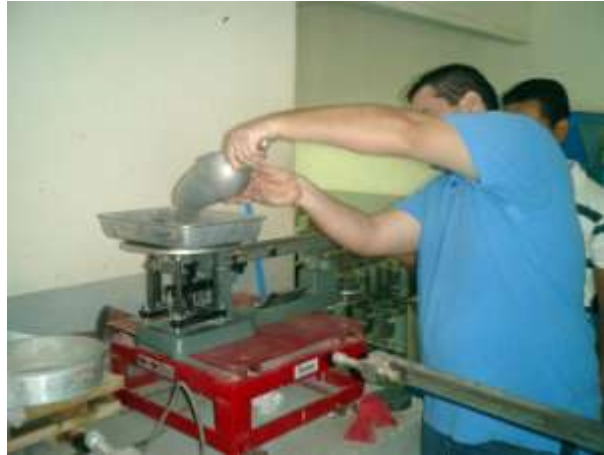
Imagen 3.02 Procedimiento para pesar la muestra seleccionada en una balanza.
