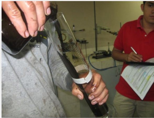
FIG. 6 4 ENSAYO DE ESTABILIDAD AL ALMACENAMIENTO 24hrs
