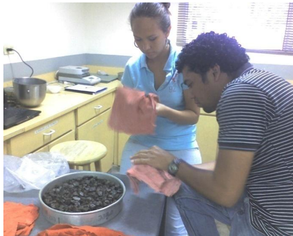
Figura N° 3.1 Eliminación del agua superficial. Fuente: Grupo de Tesis.
