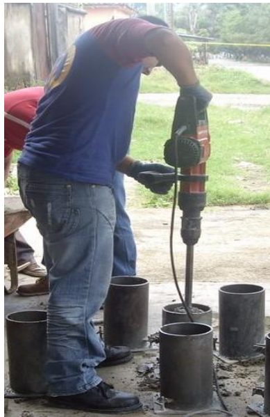
Figura N° 3.7 Compactación de cilindros con el Martillo Hilti. Fuente: Grupo de Tesis.
