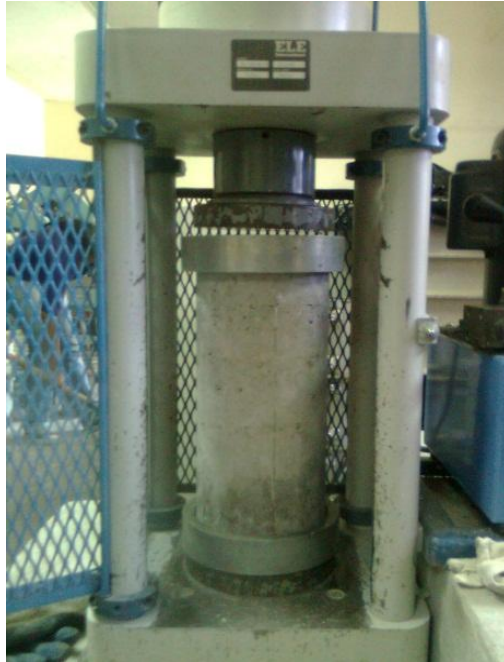
Figura N° 3.10 Colocación del espécimen para ensayo de compresión. Fuente: Grupo de Tesis.
