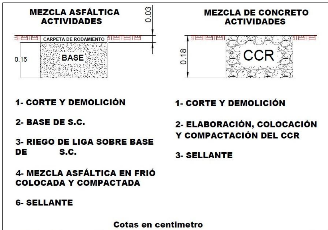
Figura N° 5.1 Estructuras de ambas técnicas de reparación de Pavimentos. Fuente: Grupo de Tesis.
