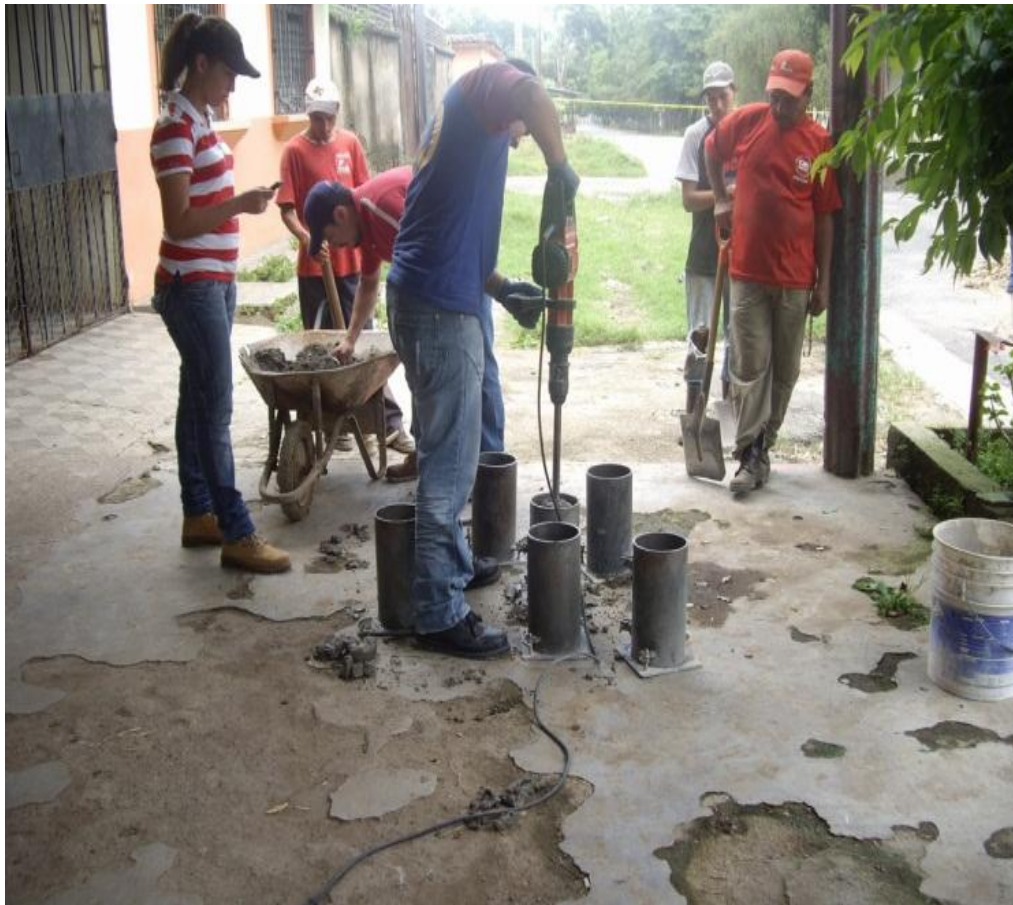
Figura N° 4.10 Elaboración de cilindros en campo, para pruebas de compresión. Fuente: Grupo de Tesis.
