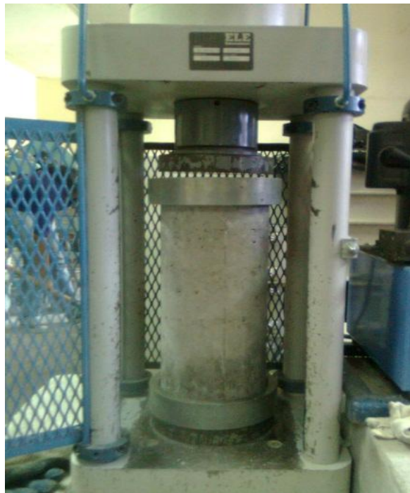
Figura N° 4.12 Prueba de Resistencia a la Compresión de especímenes Elaborados en campo (ASTM C- 39). Fuente: Grupo de Tesis.
