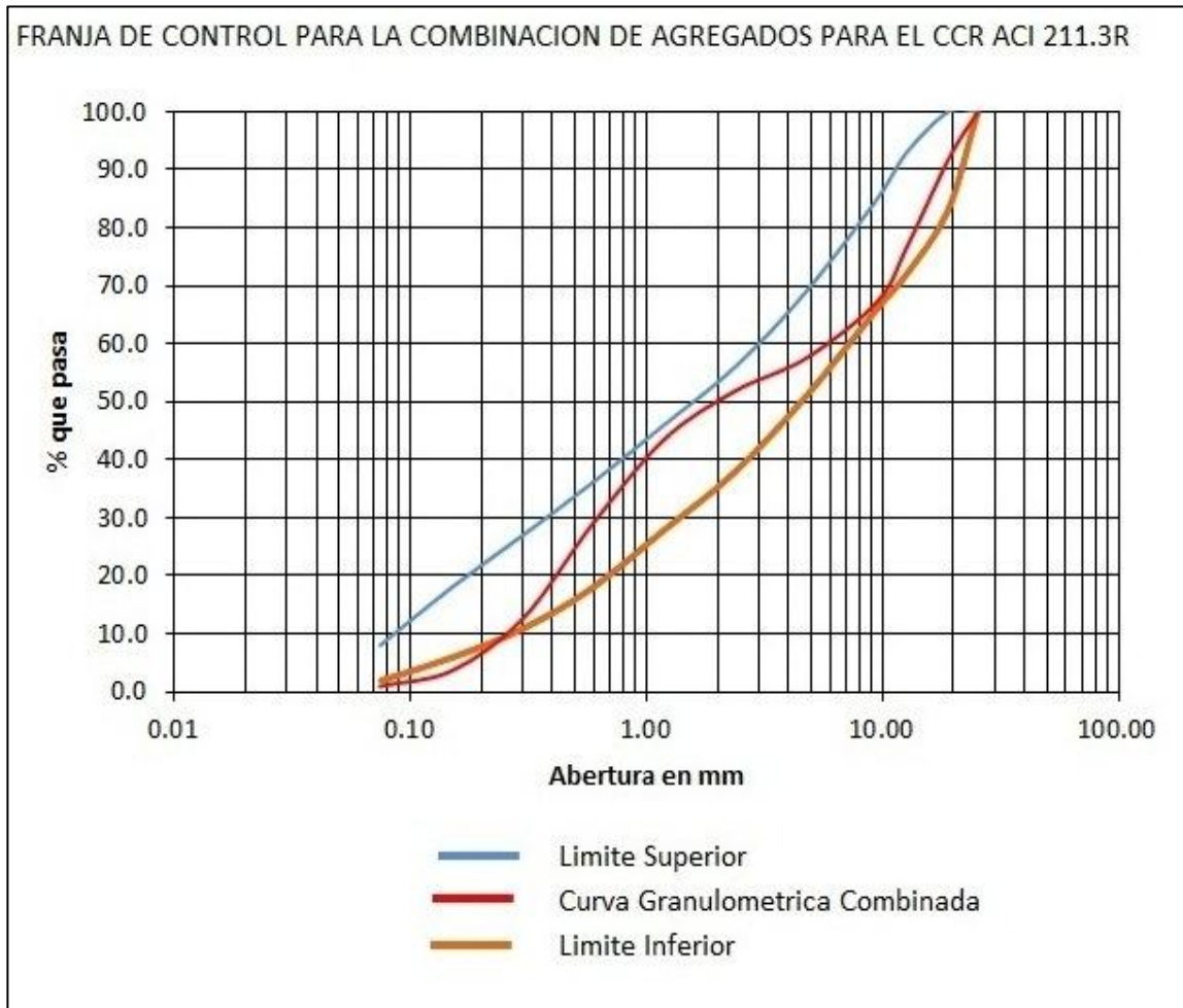
Figura N° 6.4 Curva Granulométrica Combinada con el 43% grava y el 57% arena. Fuente: Grupo de Tesis.
