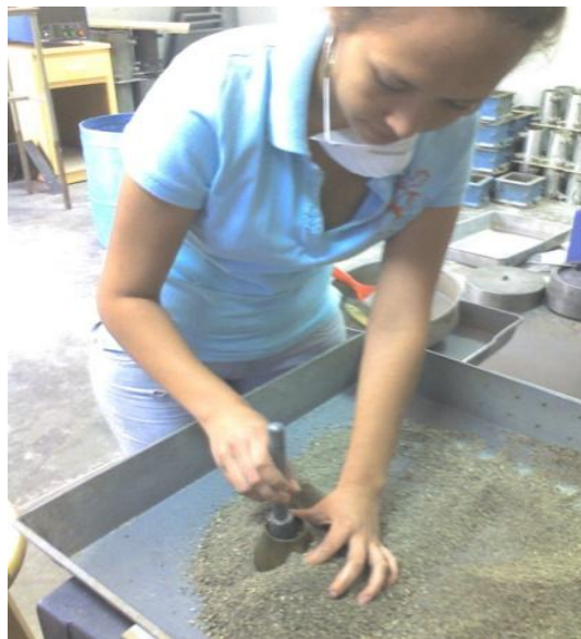
Figura N° 3.4 Determinación de la condición SSS para el agregado fino. Fuente: Grupo de Tesis.
