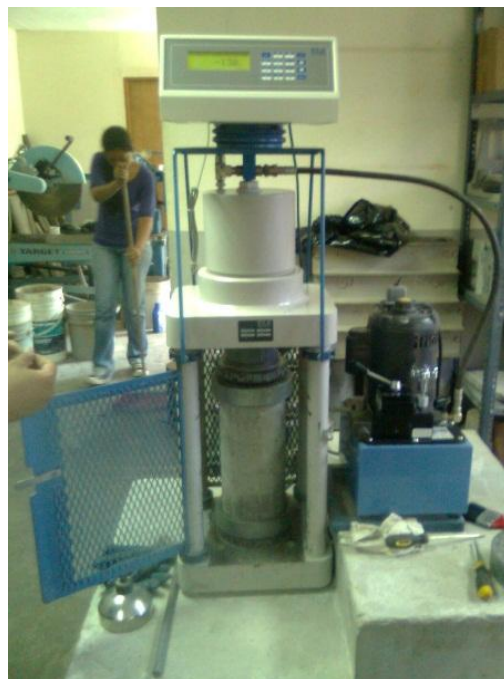
Figura N° 3.11 Especimen sometido a carga en máquina para determinar la resisten a compresión. Fuente: Grupo de Tesis.
