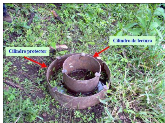
Fotografía 2.5 Anillos concéntricos para pruebas de infiltración
