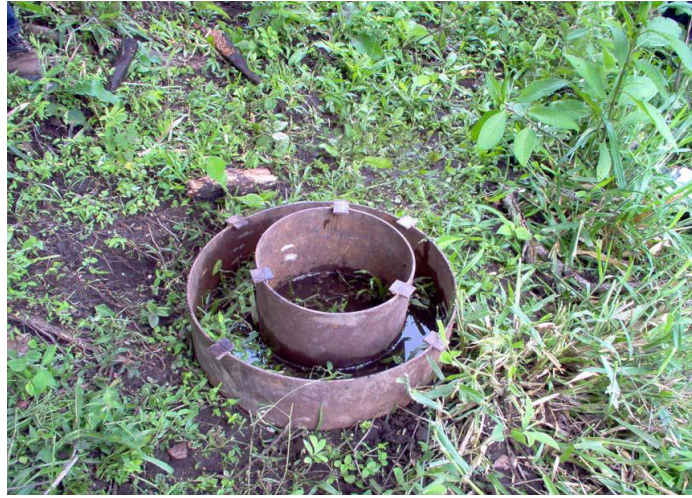
Fotografía 3.17 Prueba de infiltración en pasto.
