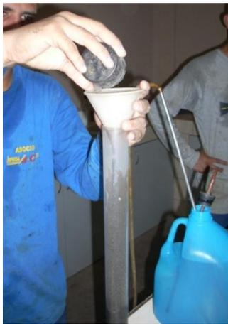
*Imagen 3.11. Vertido de agregado en probeta*
