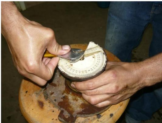
*Imagen 3.20. Aplicación de Torsión a la muestra de asfalto modificado.*
