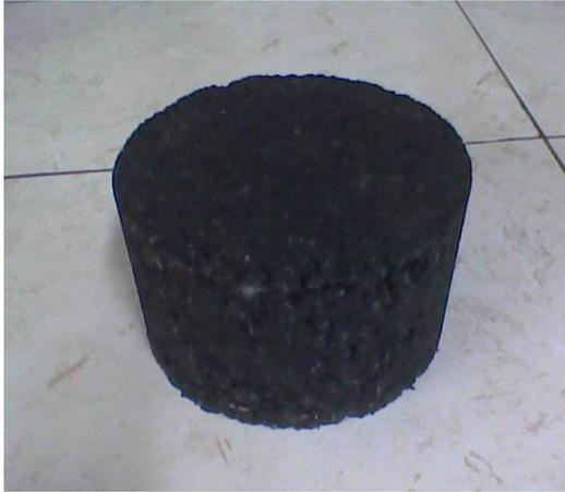
*Imagen 3.32. Briquetas antes del ensayo*
