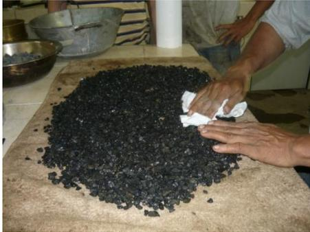
*Imagen 3.7. Secado de la superficie del agregado para obtener la condición sss*
