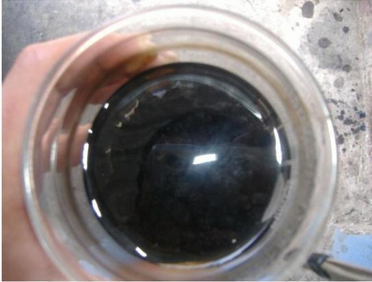
*Imagen 3.9. Retiro de asfalto de la superficie del agua*
