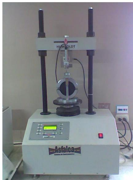
*Imagen 3.29. Aparato Marshall - medidor de estabilidad y fluencia*
