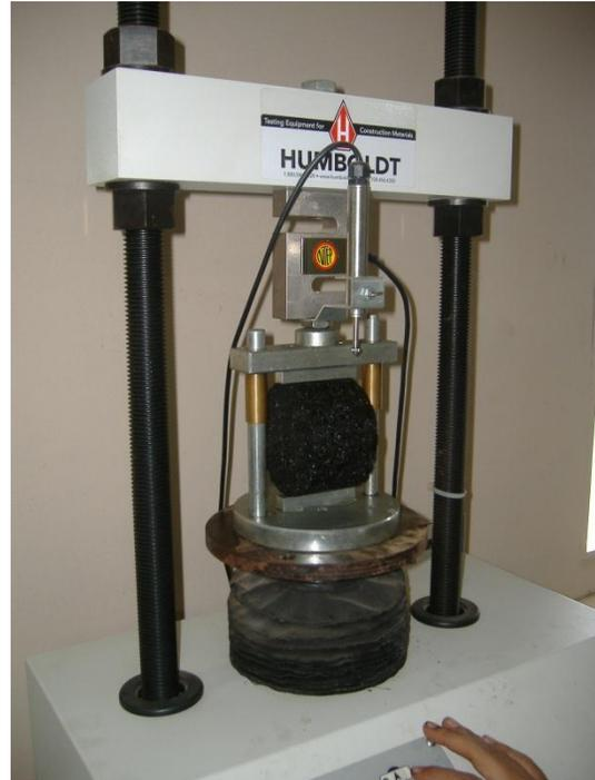
*Imagen 3.37. Aparato de carga diametral a 50 mm / min (2 pulgadas / min)*
