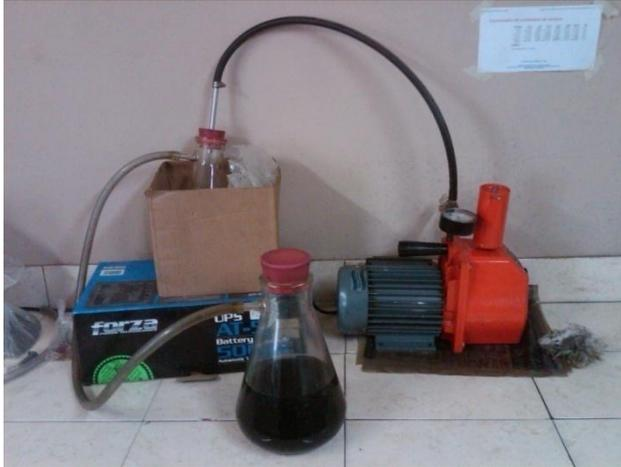
Imagen 3.26. Remoción de aire en mezcla asfáltica
