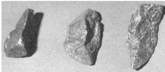
*Imagen 3.6. Fractura de partículas (bordes afilados, superficies rugosas)<sup>52</sup>*
