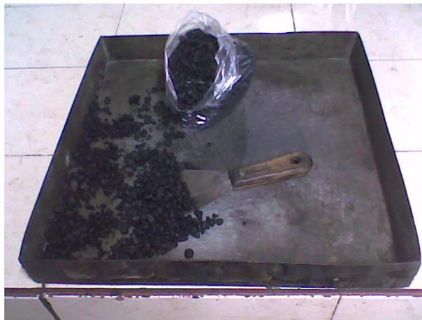
*Imagen 3.25. Mezcla asfáltica suelta*
