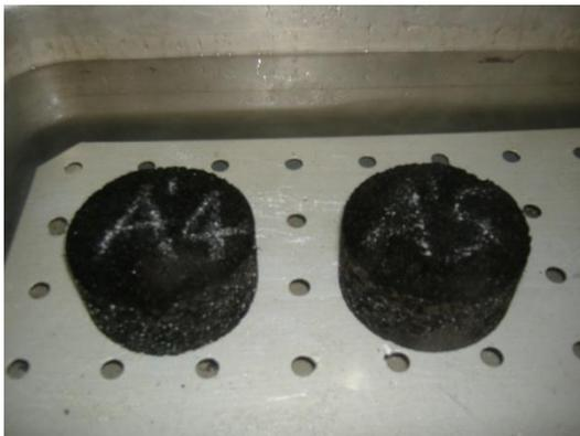
*Imagen 3.38. Subgrupos con Acondicionamiento en condición húmeda: Baño María a 60°C (140°F) por 24 hrs*
