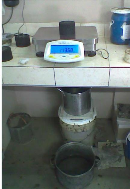
*Imagen 3.23. Peso saturado superficialmente seca del espécimen*
