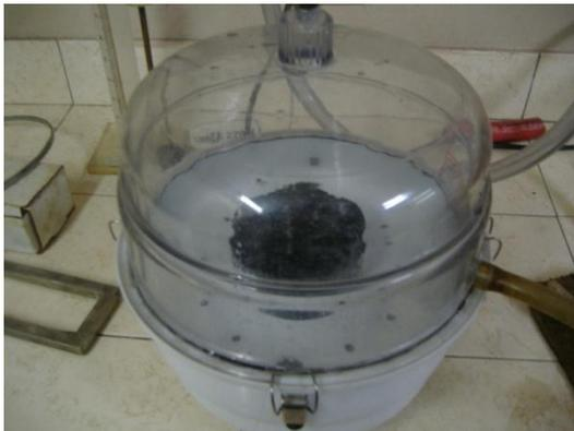
*Imagen 3.36. Subgrupo con Saturación a vacío parcial: 5min a una presión de 20 in de Hg, en agua destilada a 25°C*
