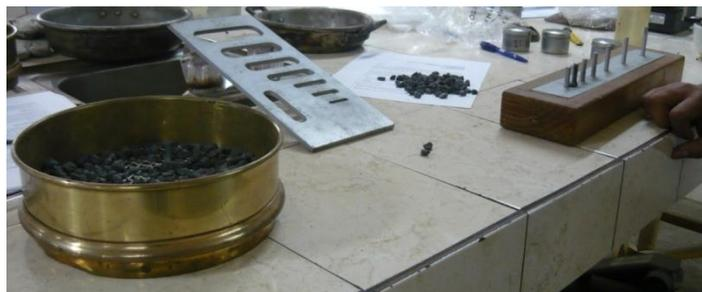
*Imagen 3.1. Ensayo de partículas en calibradores*
