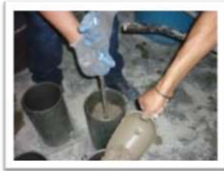
Fotografía 2.5.1 Llenado y varillado de moldes para ensayo de compresión.
