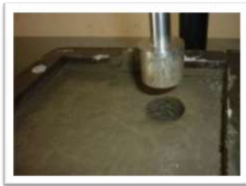
Fotografía 4.3 Ensayo de tiempos de fraguado.
