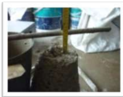
Fotografía 2.2.5 Medición de revenimiento.
