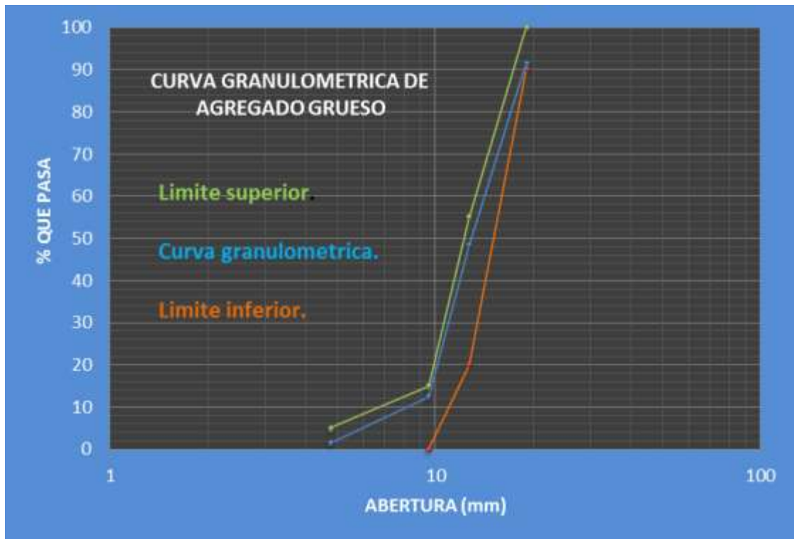
Gráfico 3.2 Curva granulométrica de agregado grueso.
