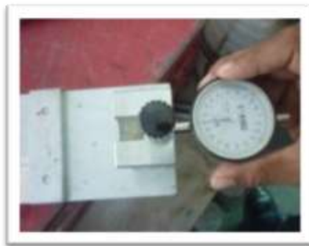
Fotografía 4.13 Montaje de dispositivo de medición de cambio longitudinal.
