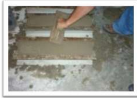
Fotografía 4.7 Acabado final de vigas para medir cambio longitudinal.
