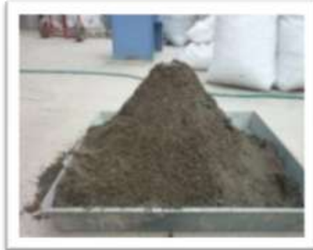
Fotografía 3.4 Muestra de ensayo, para pruebas de gravedad específica y absorción de agregados finos.
