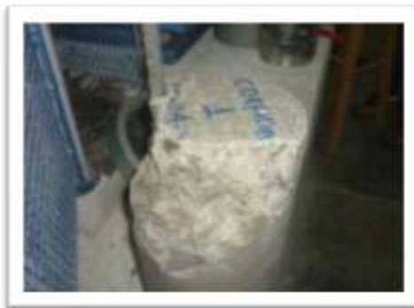
Fotografía 2.7.4 Falla en cilindro ensayado a compresión.
