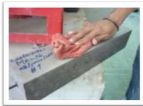
Fotografía 4.16 Preparación del espécimen antes de toma de lectura de cambio longitudinal.
