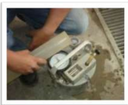
Fotografía 2.3.8 Inyección de agua en equipo de medición de contenido de aire.
