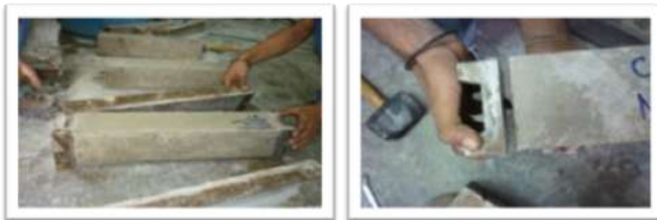
Fotografía 4.9 y 4.10 Desmoldaje de vigas de concreto para medir cambio longitudinal.
