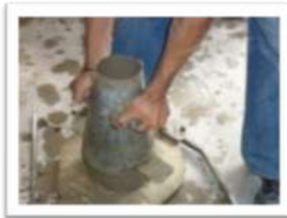
Fotografía 2.2.4 Levantamiento de molde para medir revenimiento.
