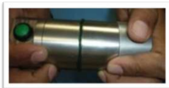
Fotografía 4.20 Ajuste de tiempo cero utilizando los transductores.
