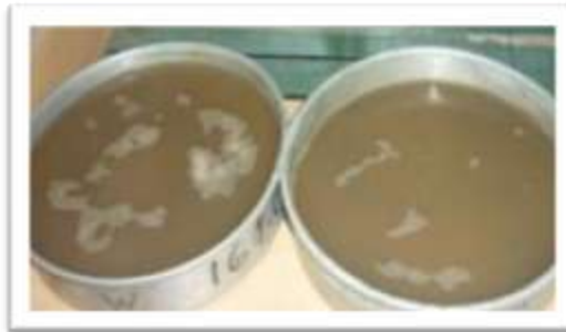
Fotografía 3.5 Saturación con agua de espécimen de ensayo.
