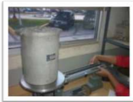
Fotografía 3.23 Determinación de masa en ensayo de densidad bruta.
