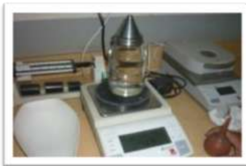
Fotografía 3.8 Procedimiento de pesado de picnómetro más contenido de agua.
