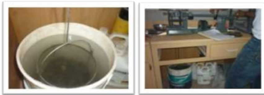
Fotografía 3.19 y 3.20 Muestra de agregado grueso en contenedor y determinación de masa aparente en agua.
