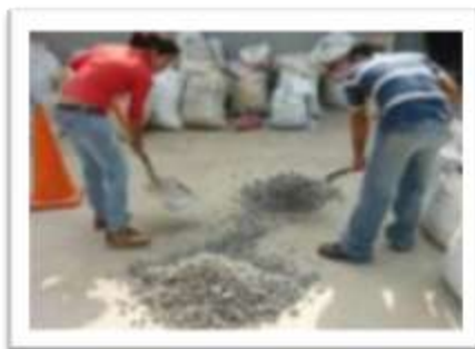
Fotografía 3.10 Homogenización de agregado grueso.
