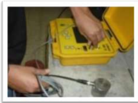
Fotografía 4.18 Preparación de equipo generador de pulso ultrasónico.
