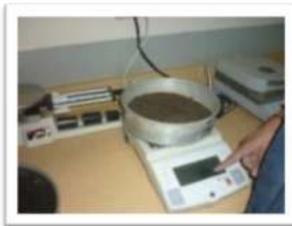
Fotografía 3.3 Procedimiento de pesado de porciones retenidas en mallas.
