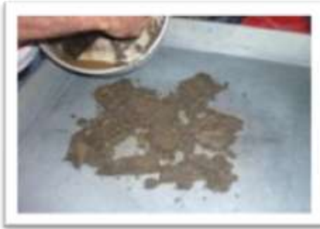
Fotografía 3.7 Prueba manual para alcanzar la condición superficie superficialmente seca (SSS) de la muestra.
