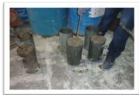
Fotografía 2.5.3 Moldes para compresión completamente llenos.
