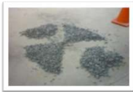
Fotografía 3.21 Cantidad de agregado grueso para ensayo de Densidad Bruta.
