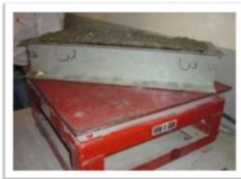
Fotografía 4.6 Consolidación de vigas para medir cambio longitudinal.
