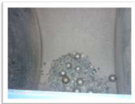
Fotografía 3.24 Muestra de ensayo mas carga abrasiva en maquina de los ángeles.
