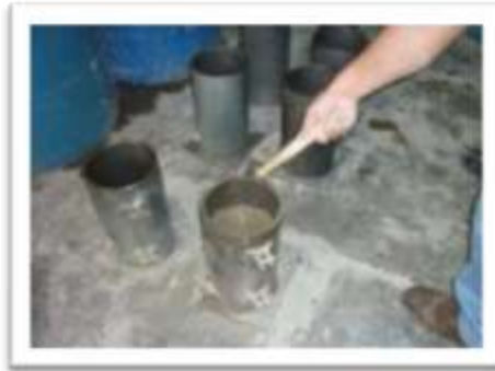
Fotografía 2.5.2 Liberando burbujas de aire en moldes para compresión.
