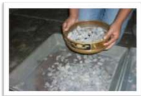
Fotografía 3.26 Tamizado de muestra ensayada en maquina de los ángeles.
