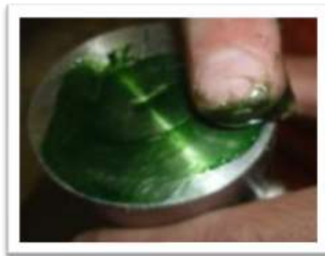
Fotografía 4.19 Engrasado de caras de transductores.
