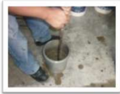
Fotografía 2.3.1 Primera capa en ensayo de contenido de aire.
