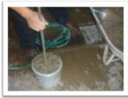
Fotografía 2.3.4 Tercera capa en ensayo de contenido de aire.
