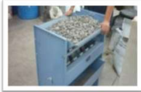
Fotografía 3.12 Cuarteo mecánico de agregado grueso.
