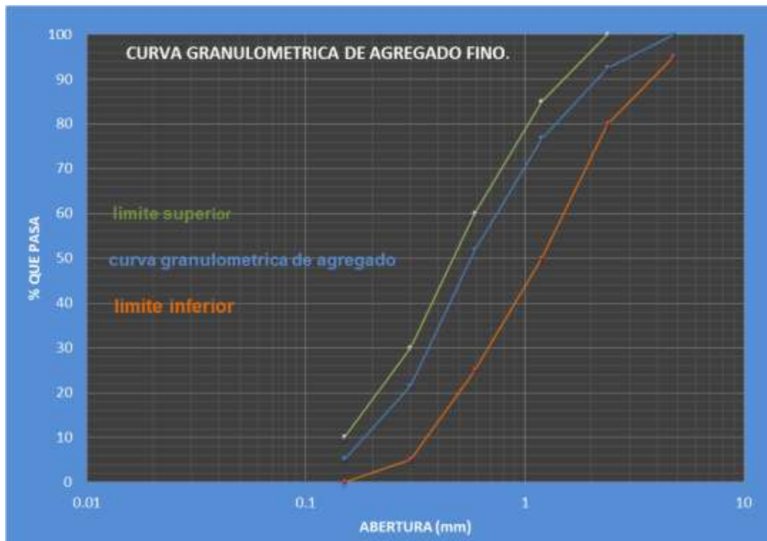
Gráfico 3.1 Curva granulométrica de agregado fino.
