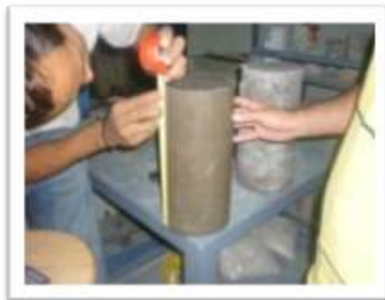
Fotografía 2.7.2 Toma de dimensiones de cilindros para compresión.
