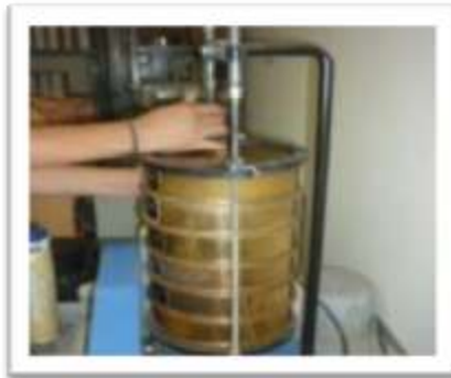
Fotografía 3.2 Tamizado mecánico de muestra.
