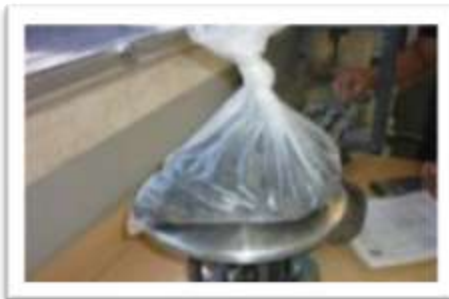
Fotografía 3.18 Peso de muestra de agregado grueso en condición SSS.
