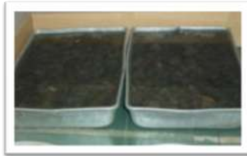
Fotografía 3.17 Saturación de muestra de agregado grueso.
