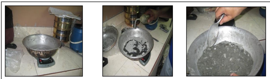
FIG 3.11 Adición y mezclado de Agua para Alcanzar contenido optimo de humedad.
