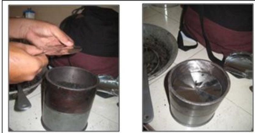
FIG 3.15 Colocación de Papel parafinado para evitar perdida de material.
