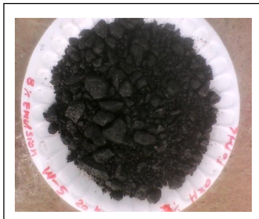
FIG.3.9 Muestra de ensayo de recubrimiento con 8% de humedad
