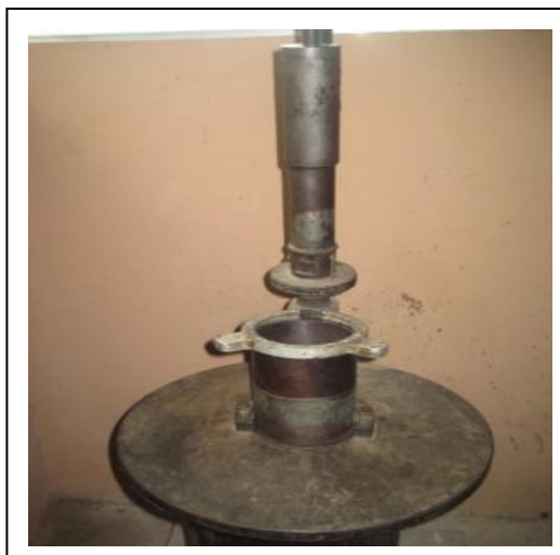
FIG 3.16 Compactación de mezcla Aplicando Carga con martillo Marshall
