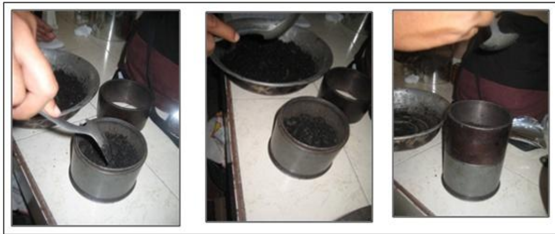
FIG 3.13 Colocación y Distribución del Material dentro del Molde.
