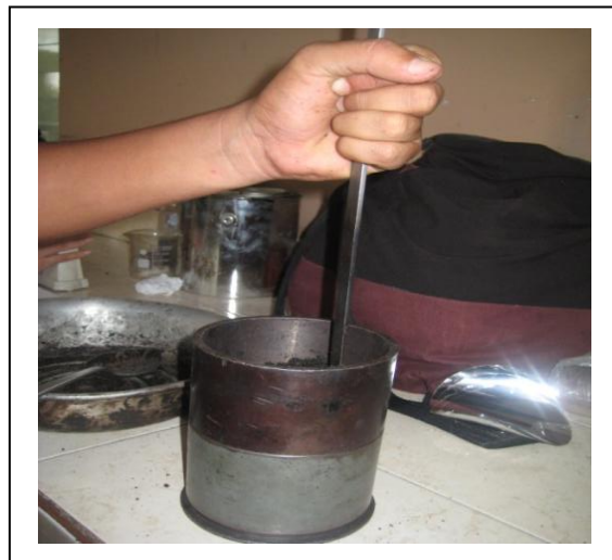
FIG 3.14 Punzonamiento de mezcla para evitar formación de hormigueros junto a las paredes.
