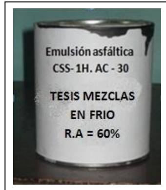
FIG 3.10 Emulsión utilizada en el diseño de la mezcla.
