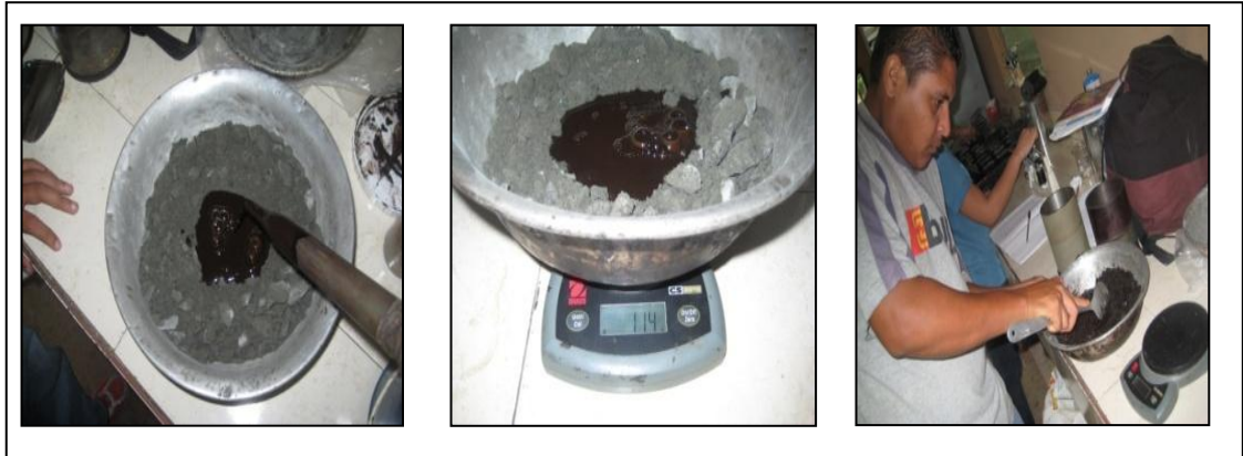
FIG 3.12 Colocación del porcentaje de emulsión y mezclado de materiales.
