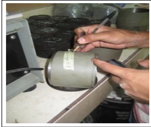
FIG 3.17 Rotulación y curado de briquetas
