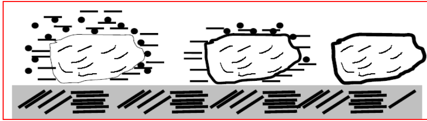
FIGURA 2.11 Ruptura de una Emulsión Asfáltica sobre un Material Pétreo.
