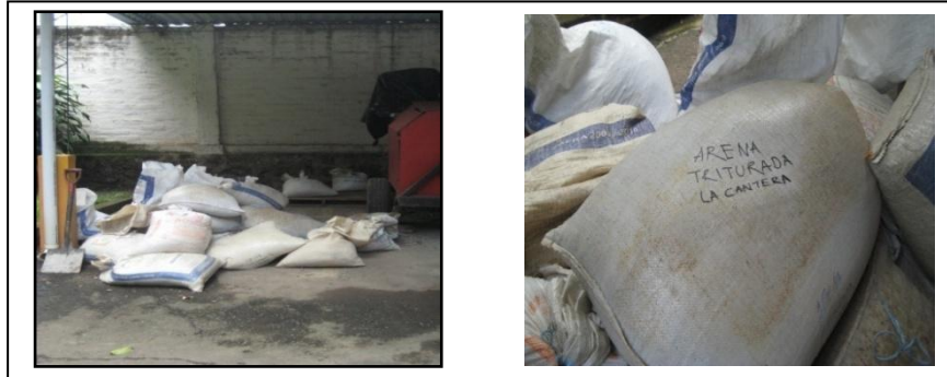
FIG. 3.4 Almacenamiento de Muestras en sacos con su debida identificación.
