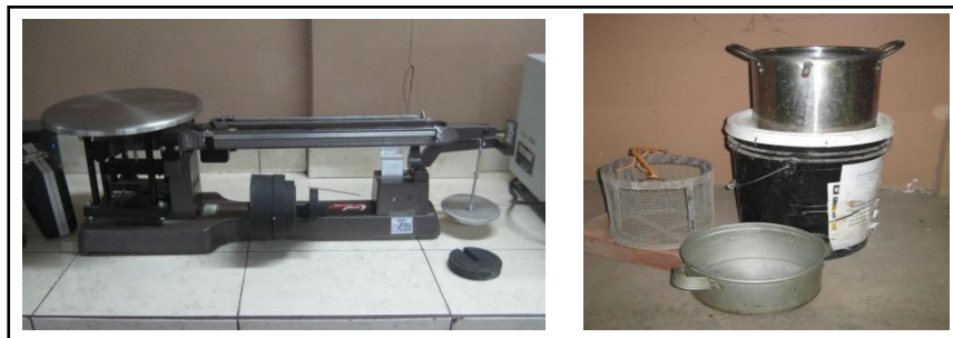
FIG.3.7 Equipo y herramientas para realizar ensayo de Gravedad Especifica
