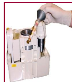
4. Remover la columna
