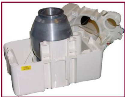
5. Remover el revestimiento de plomo
