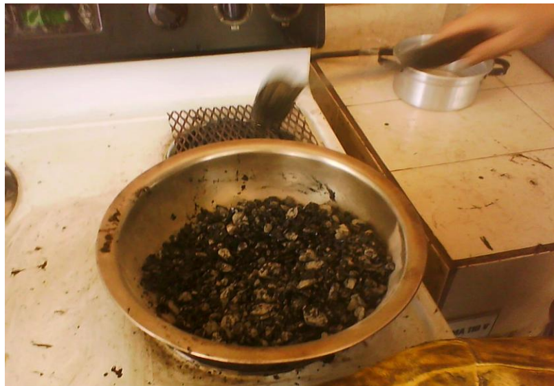
Fotografía 1.5. Proceso de mezclado del pétreo con el asfalto.
