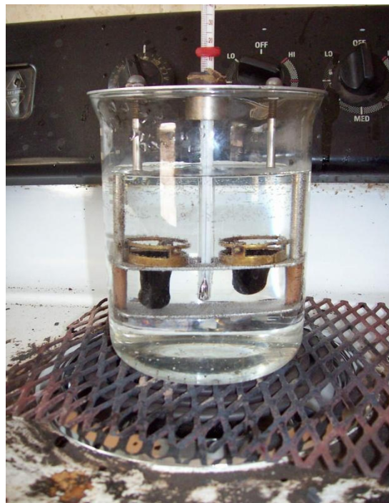
Fotografía 4.2. Caída de esferas en ensayo de punto de ablandamiento.
