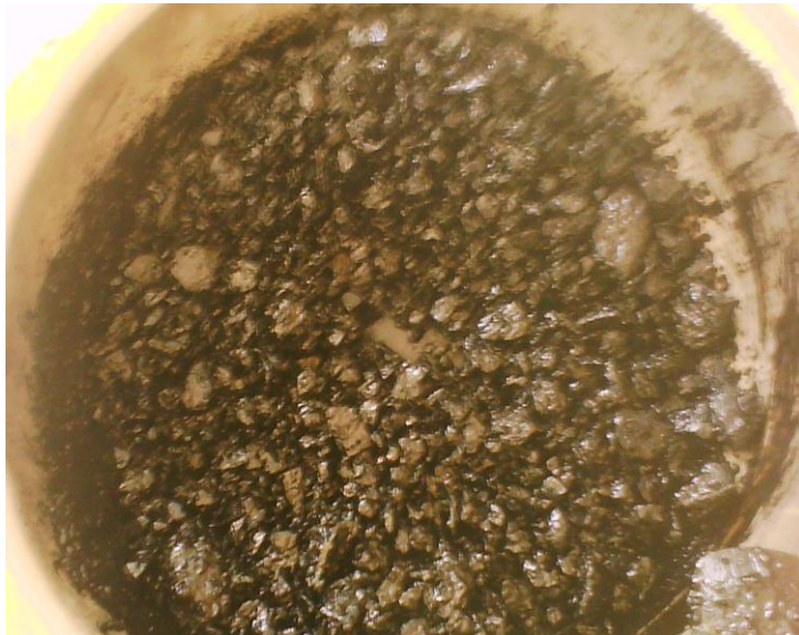
Fotografía 4.7. Finalización del proceso de mezclado. Pétreo totalmente recubierto.
