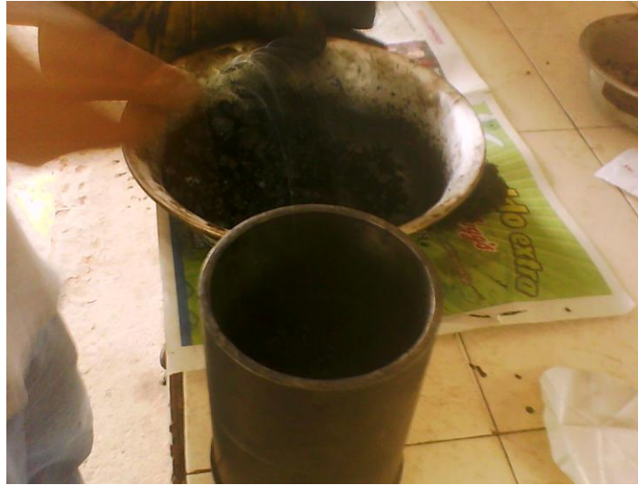
Fotografía 4.8. Colocación de la mezcla en el molde Marshall.
