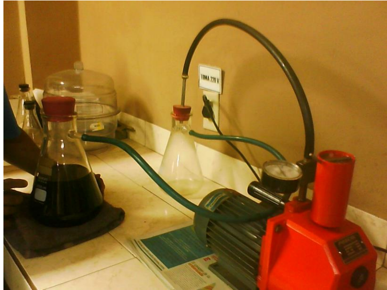
Fotografía 4.45. Equipo de agitación y picnómetro.
