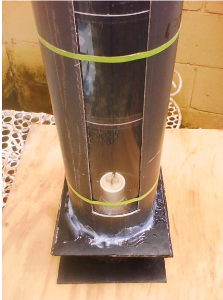
Fotografía 4.22 Permeámetro LCS hecho a mano.
