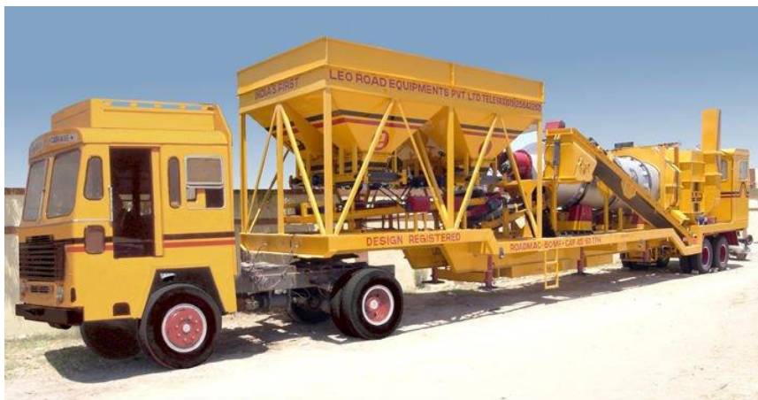
Fotografía 2.5. Planta asfáltica tipo drum-mix 22 .
