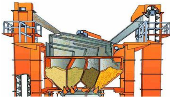
Fotografía 2.2. Planta asfáltica discontinua 19 .
