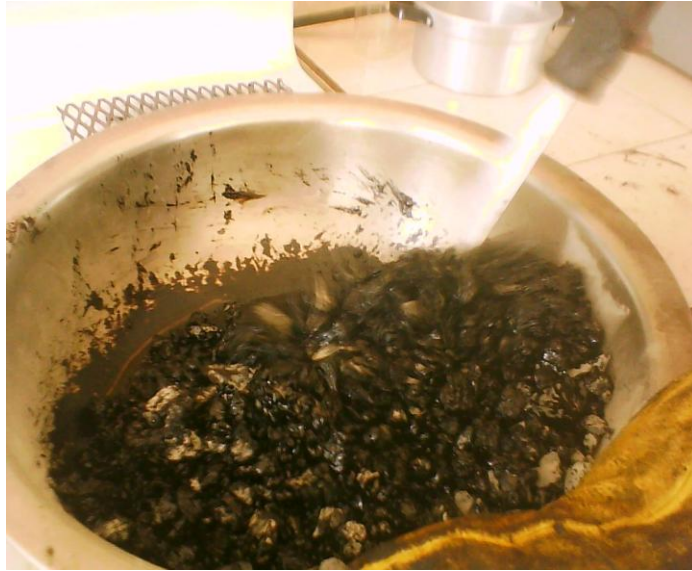
Fotografía 4.6. Mezclado del asfalto con el pétreo.
