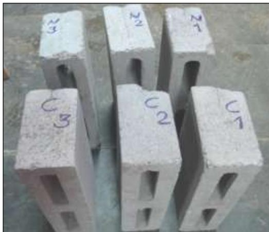
ILUSTRACIÓN 10: BLOQUES DE CONCRETO BAJO NORMA Y COMERCIAL.
