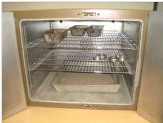
ILUSTRACIÓN 13: ARENA PROVENIENTE DEL RÍO JIBOA SECADA AL HORNO.
