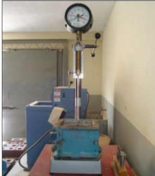
ILUSTRACIÓN 24: EQUIPO PARA LA PENETRACIÓN DEL ESPÉCIMEN.
