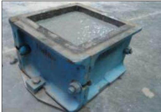
ILUSTRACIÓN 23: MOLDE CON MUESTRA PARA PRUEBA DE TIEMPO DE FRAGUADO.
