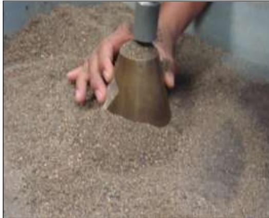
ILUSTRACIÓN 16: PRUEBA DEL CONO.
