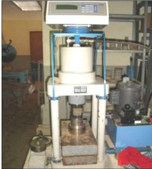
ILUSTRACIÓN 21: CUBOS DE MORTERO SOMETIDOS A CARGA DE COMPRESIÓN.
