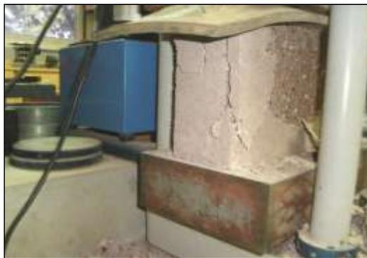
ILUSTRACIÓN 12: BLOQUE DE CONCRETO SOMETIDO A COMPRESIÓN.
