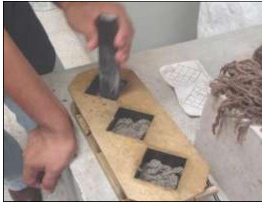
ILUSTRACIÓN 20: APISONADO DEL MORTERO PARA ESPECÍMENES.
