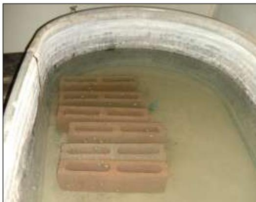
ILUSTRACIÓN 11: BLOQUES DE CONCRETO DENTRO DE TANQUE CON AGUA.
