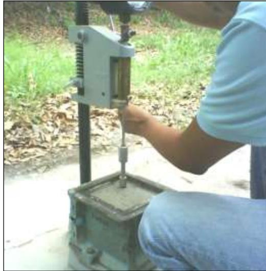
ILUSTRACIÓN 27: EQUIPO DE PRUEBA PARA REALIZAR TIEMPO DE FRAGUADO.
