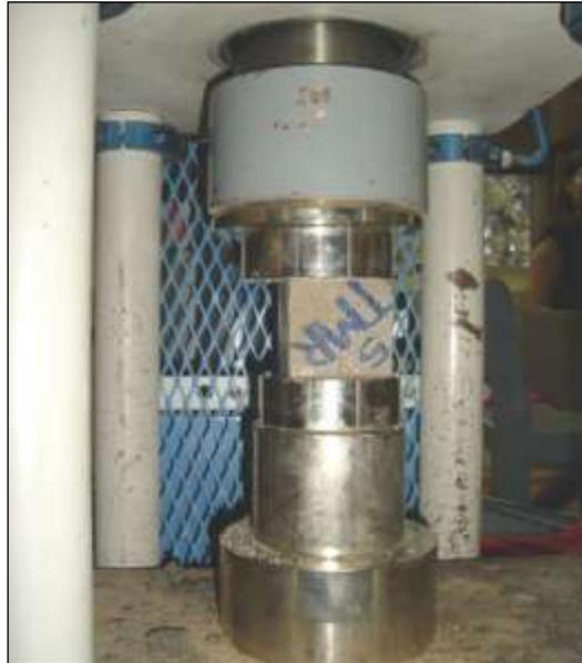
ILUSTRACIÓN 26: CUBO SOMETIDO A CARGA DE COMPRESIÓN.
