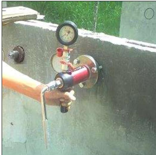
ILUSTRACIÓN 29: EQUIPO DE MEDICIÓN DE LA ADHERENCIA.
