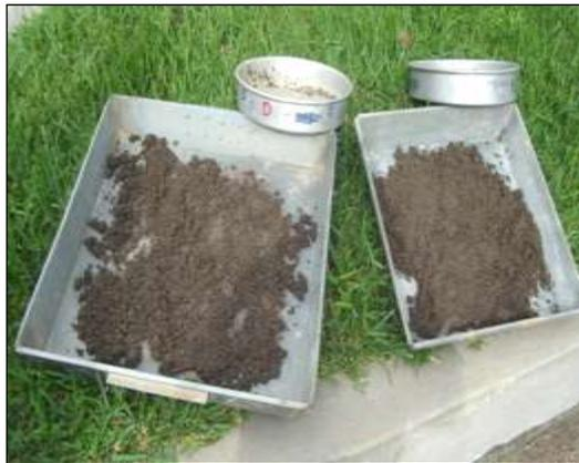
ILUSTRACIÓN 15: ARENA DEL RÍO JIBOA SECADA AL SOL.
