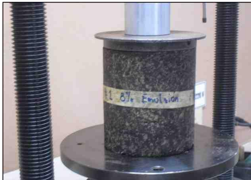
Fig. 3-24: ensayo de compresión en estado satura parcialmente
