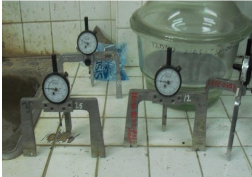
Fig. 3-6: Micrómetros para medir deformaciones
