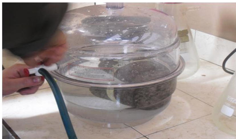
Fig. 3-23: Briquetas en inmersión por 30 minutos a una presión de 10 cmHg
