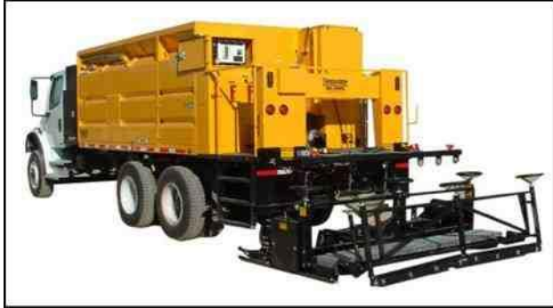
Fig. 5-1: Camión de fabricación y extendido de slurry/Microsurfacing
