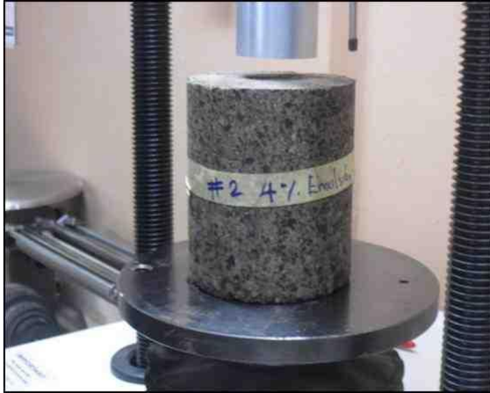
Fig. 3-22: ensayo de compresión en estado seco
