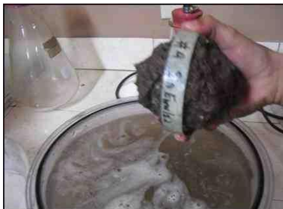
Fig. 3-26: briqueta totalmente deformada después de la saturación parcial.
