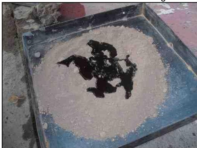
Fig. 3-16: Mezcla de Suelo, Emulsión y Agua
