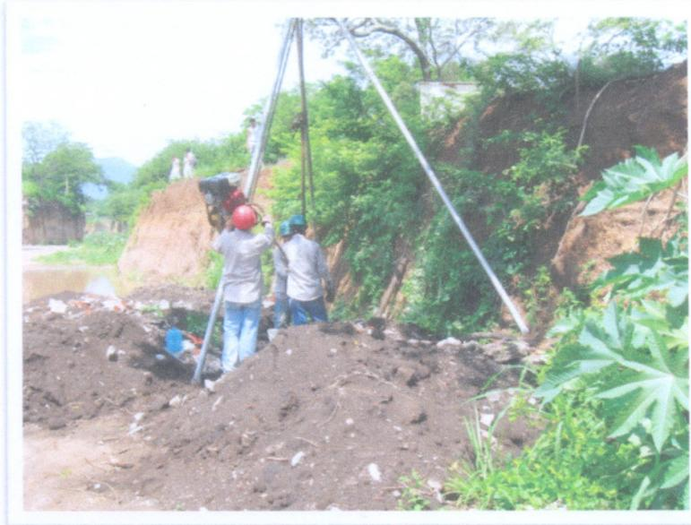
*Fotografía N°3: Mostrando la ejecución del sondeo S-3, ubicado al pie del talud sobre Avenida al Chupadero.*
