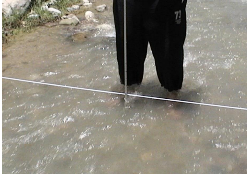
IMAGEN 4.3: MEDICION DE ALTURAS DE LA SECCION TRANSVERSAL
