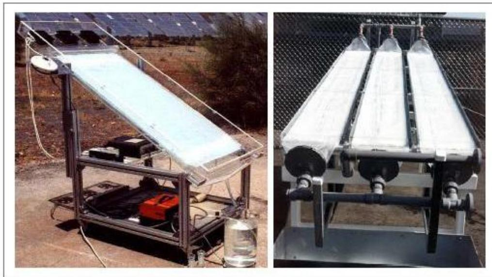
Fig. 3.17 Izquierda captador solar estático de placa inclinada cerrada con catalizador( $\text{TiO}_2$ ) soportado para aplicaciones fotocatalíticas (Plataforma solar de Almería). Derecha: prototipo de captador tubular (National Renewable Energy Laboratory, USA)
