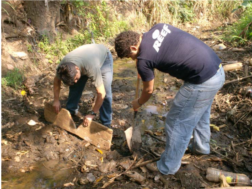
Foto 1. Realización de aforo en el río El Porvenir en época seca.
