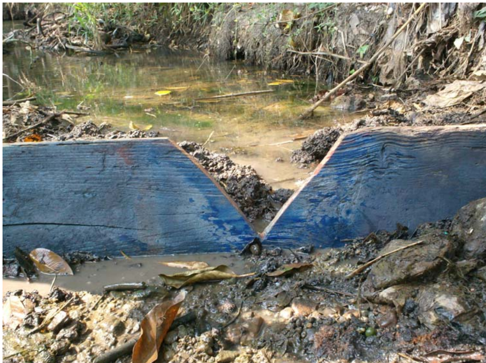
Foto 2. Vertedero triangular como herramienta para la obtención del caudal en época seca.
