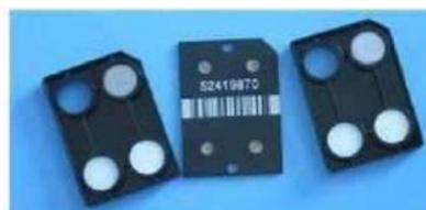
*Vista interior de un dosímetro de termoluminiscencia*
