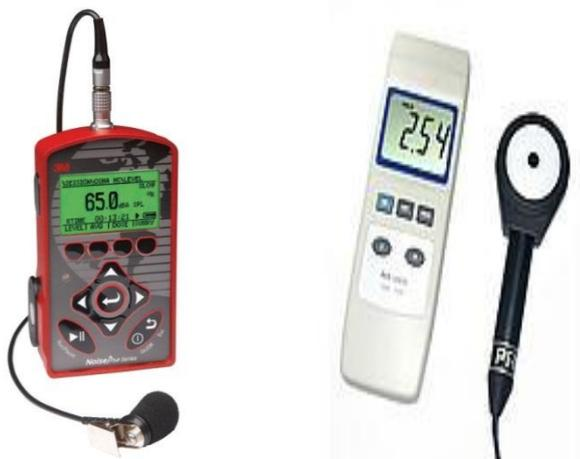
Estos dosímetros permiten seleccionar la tasa de advertencia en un amplio rango de valores de tasa de exposición y son especialmente útiles cuando por ejemplo, se remueven blindajes de una fuente de radiación. Los dosímetros de alarma y emergencia deben ser empleados solo como dosímetros suplementarios.
