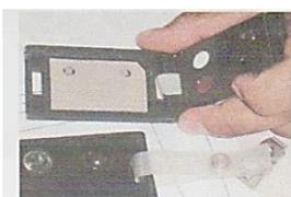
Fig. 22 Extracción de cristales TLD.
