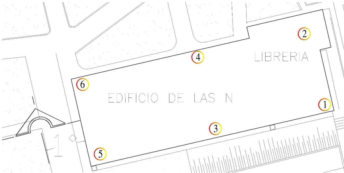
Figura 262. Vista en planta del método de 4 esquinas con "Solar Path-finder".
