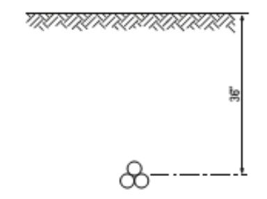
Figura 89. Configuración en triángulo o “trifoil”. (Nreca, 2008, figura 4.6)
