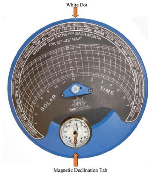
Figura 202. Foto de carta solar con ajuste de declinación magnética de 11 grados al Este del Norte (+11°)
