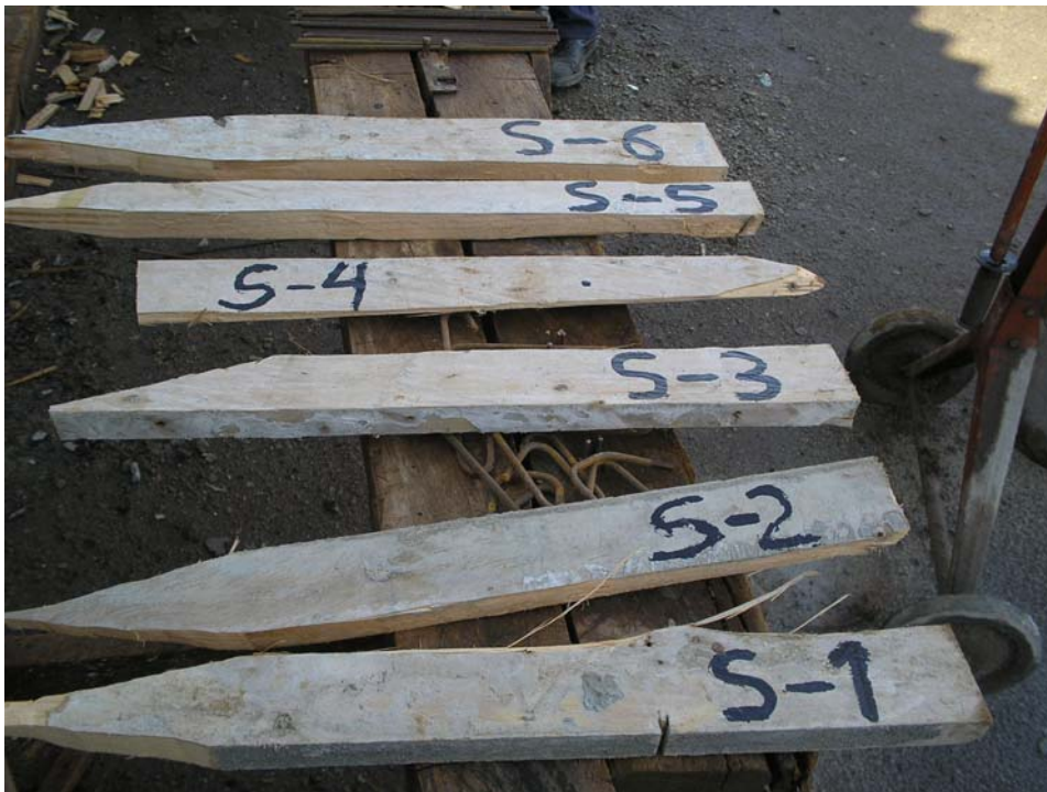
Anexo 8a. Estacas con la respectiva numeración para identificación del sondeo
