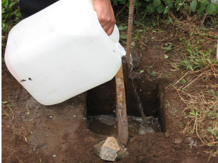
ANEXO 10c. Colocación de agua hasta la medida establecida como referencia.
