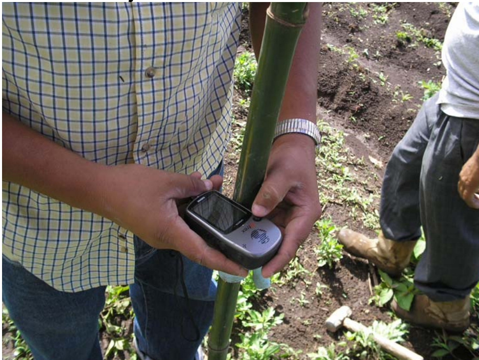
Anexo 8d. Toma de coordenadas en cada punto del sondeo, con equipo GPS GARMIN
