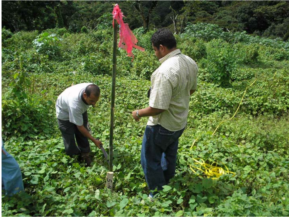
Anexo 8c. Colocación de vara de madera junto a Estaca para mejor visualización del sondeo
