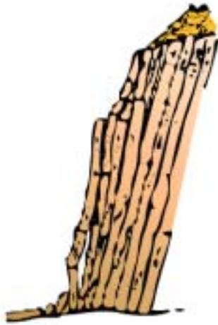
FIG. 1.16 Pandeo por flexión de placas fracturadas
