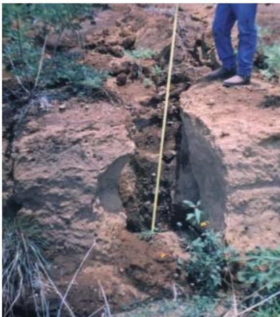
**Figura 2.30a:** Desgaste de masas producidas por el viento y la escorrentía superficial
