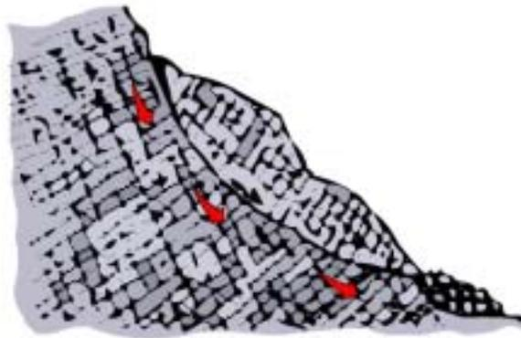
FIG. 1.8 Deslizamiento rotacional en macizo rocoso muy fracturado
