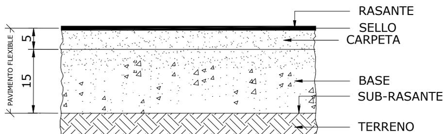
**Figura III-10. Sección de Diseño**
