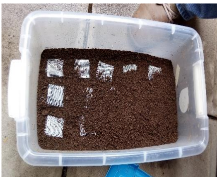
Figura 3-19. Reactor para la prueba de biodegradabilidad.
