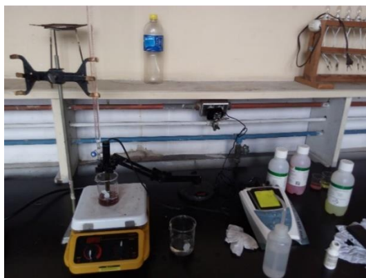
Figura 3-29. Toma del volumen para el cálculo de acidez titulable.
