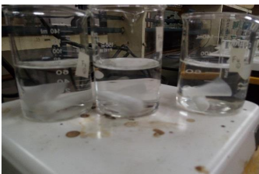
Figura 3-16. Biopelículas en agua y con agitación constante.
