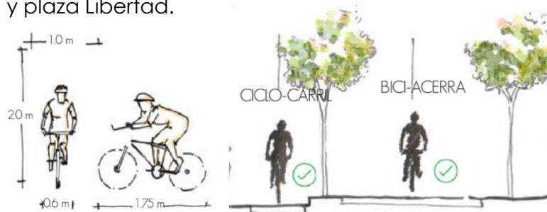
Imagen IPRL-04 Medidas reglamentarias ciclovía Fuente: Manual de diseño de urbanismo y construcción
