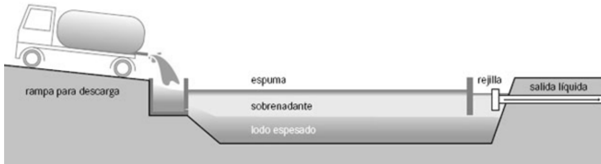
Figura 44 Tanque de espesamiento de lodos.
