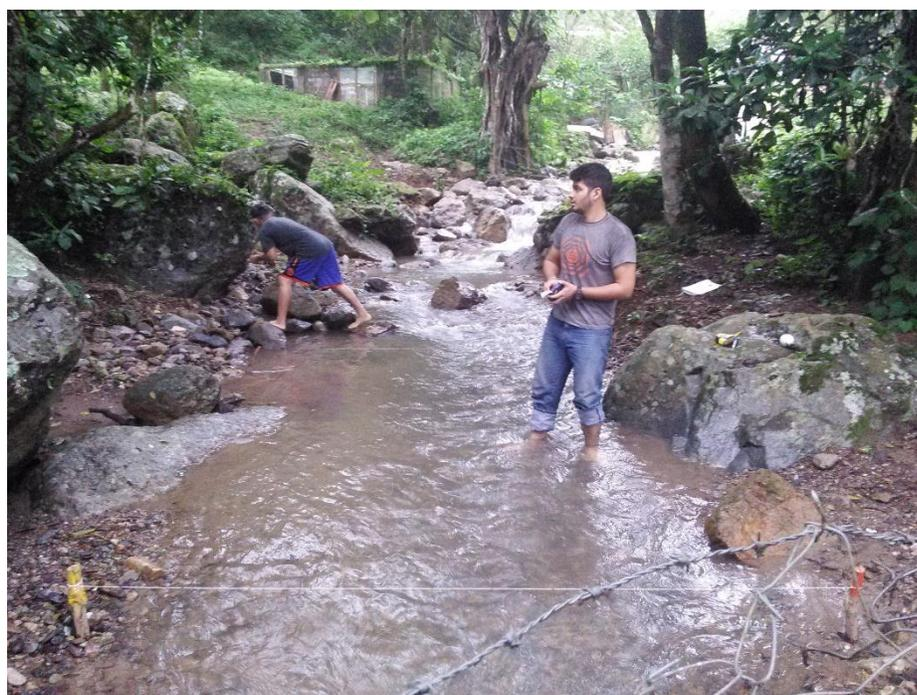
**Imagen No. 8: Aforo en Río Cristiani, Método Velocidad Superficie.**
