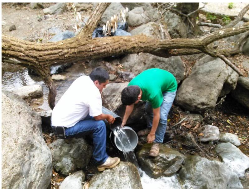
**Imagen No. 6: Aforo en La Cascada, Método Volumétrico.**
