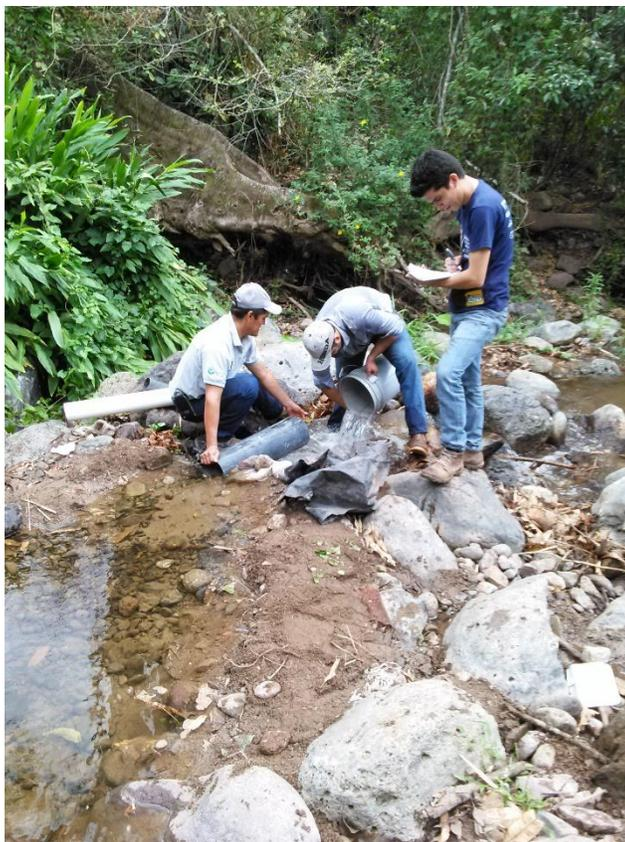
**Imagen No. 5: Aforo en La Molienda, Método Volumétrico.**
