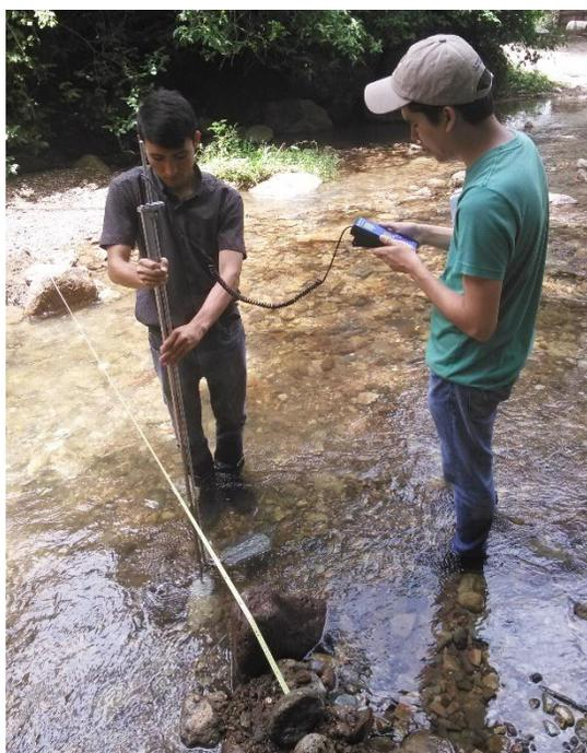
**Imagen No. 10: Aforo en La Molienda, Método Velocidad-Superficie con Molinete.**
