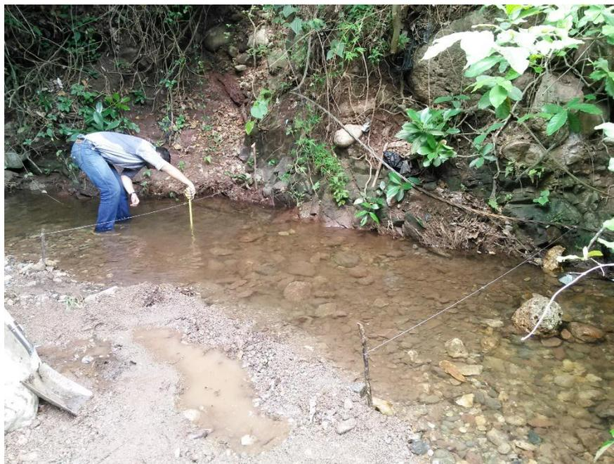
**Imagen No. 7: Aforo en La Molienda, Método Velocidad-Superficie.**
