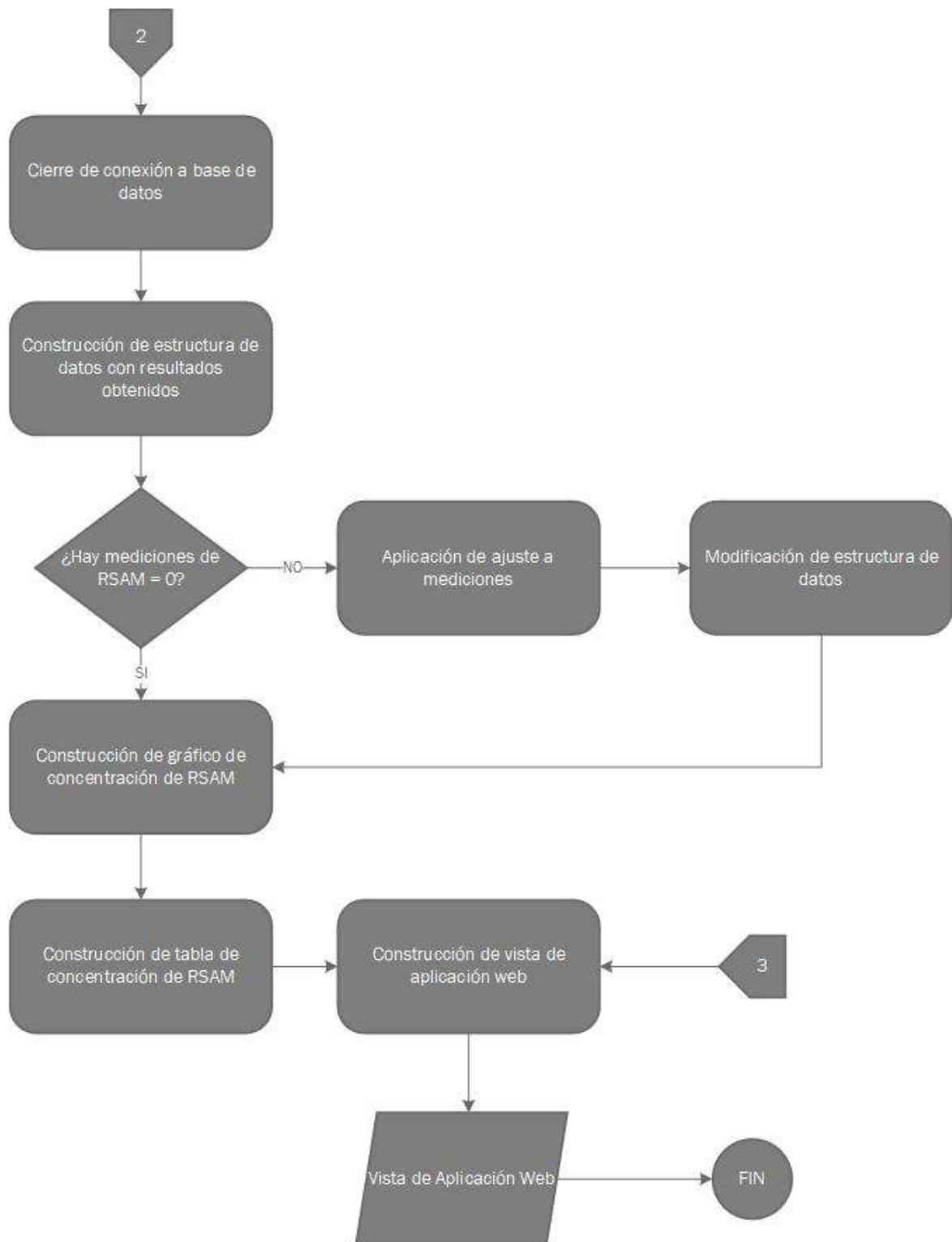
Figura 3.20 - Diagrama de flujo de proceso despliegue de gráfico de RSAM por rango
