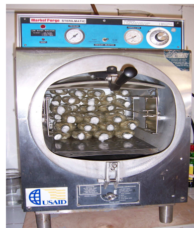
Figura 7. Preparación y esterilización del arroz para la producción B. bassiana .
