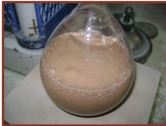
IMAGEN 5.14: EXTRACCIÓN DEL AIRE DE LA LECHADA POR MEDIO DE CALOR.
