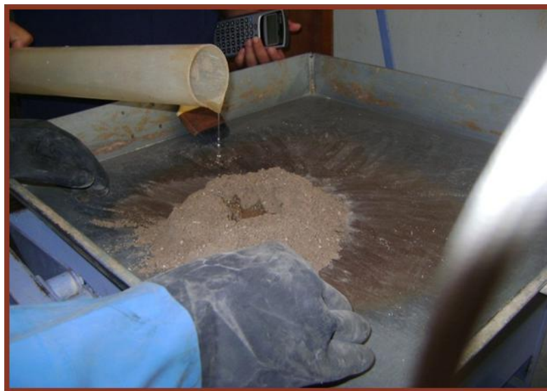
IMAGEN 5.18: HOMOGENIZADO DE MEZCLA DE SUELO-CEMENTO
