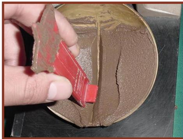
IMAGEN 5.9: CANAL HECHO POR EL RANURADOR.
