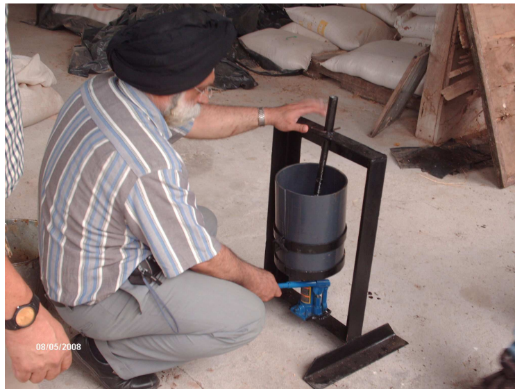
Figura A-4 Elaboración de bloques con prensa hidráulica
