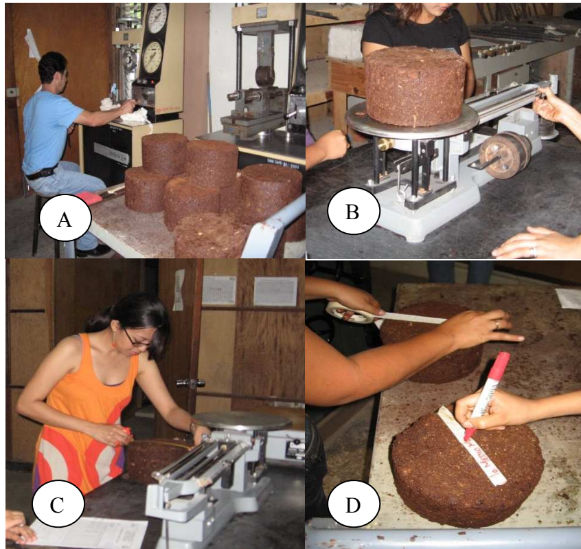
Figura 8. a. Preparación de los BMN, b. Pesado, c. Medición, d. Identificación.
