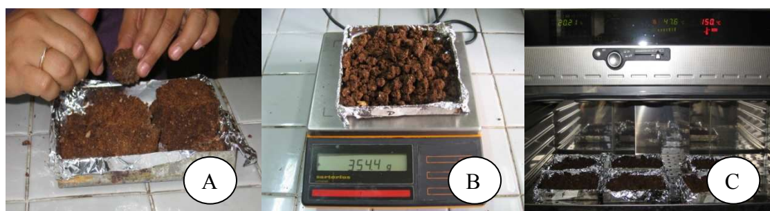
Figura 10. a. Preparación de las muestras, b. pesado, c. secado.
