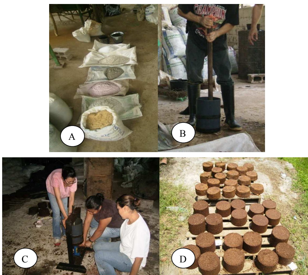
Figura 6. a. Materias primas, b. Compactación manual, c. Compactación con prensa, d. Bloques terminados.
