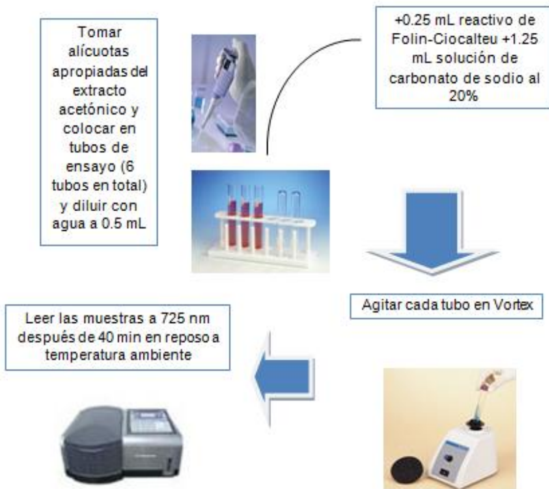
Figura N° 20. Esquema para la cuantificación de fenoles totales. Preparación del extracto de taninos. Método de Folin-Ciocalteu. (17)
