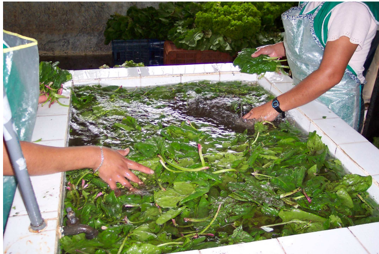
Fig.7. Proceso de lavado del producto, en pilas que generalmente contienen agua o algún producto desinfectante.
