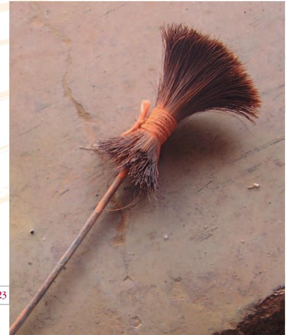
23. Pincel artesanal de pelo de buey fabricado en el taller, es utilizado para recubrir con vidriado las pequeñas reparaciones en piezas averiadas.
