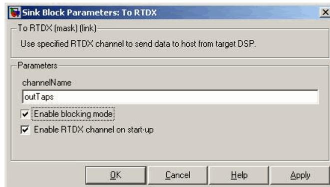
Figura 4.28 Opciones bloque "To RTDX" en Simulink.
