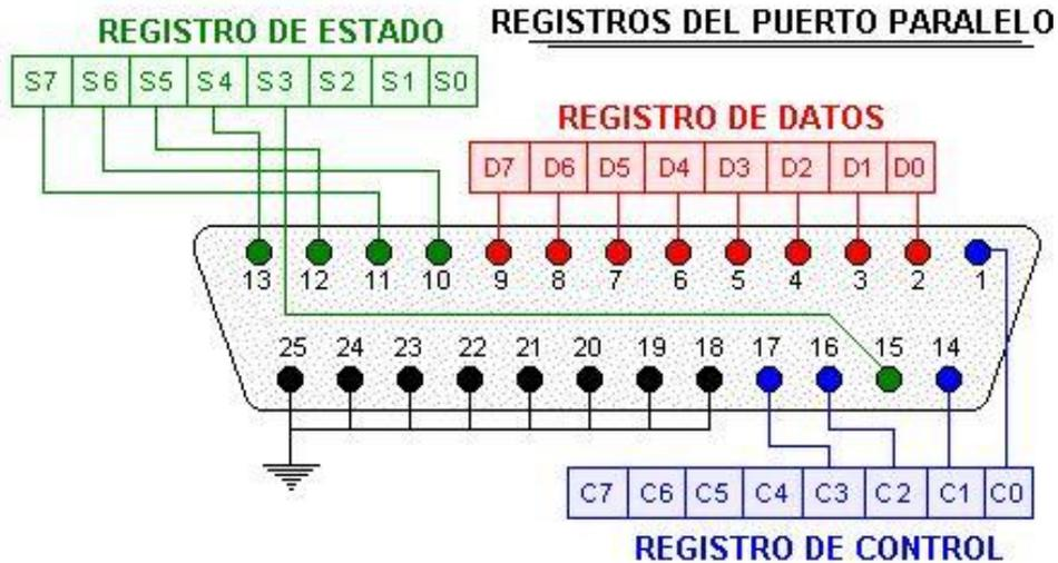
Figura 4.13 Distribución de los pines del conector P3.
