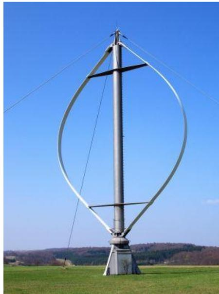
Figura 1.1 Turbina de Eje Vertical tipo Darreius.
