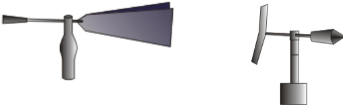
Figura 4.19 Veleta de paletas separadas (Izq.) y Veleta de paleta típica (Der).
