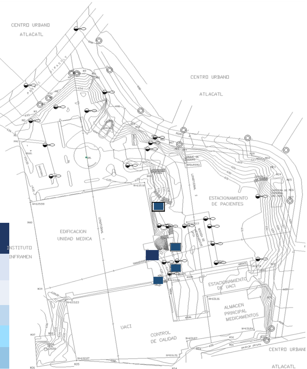
Plano 07. Red de Sistema Hidráulico de la Unidad Médica de Especialidades Atlacatl. Sin Escala
