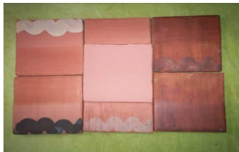
Figura N. 58 pruebas de engobe rojo El Sauce
