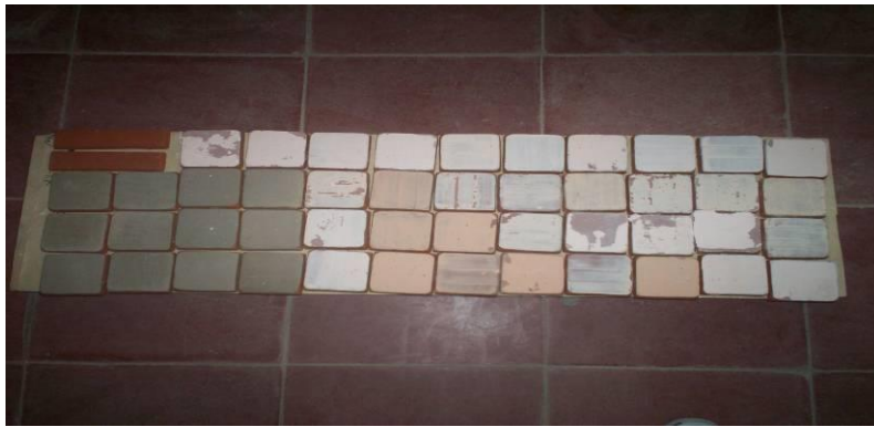
Figura N. 43 pruebas 3 engobes base blancos horno de leña
