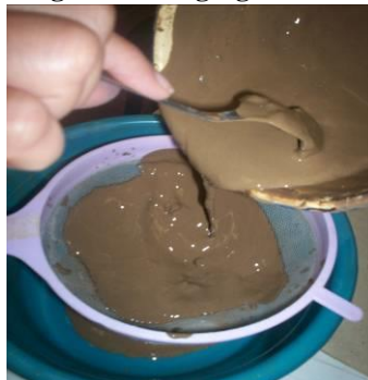
Figura N 68 agregado de barro liquido
