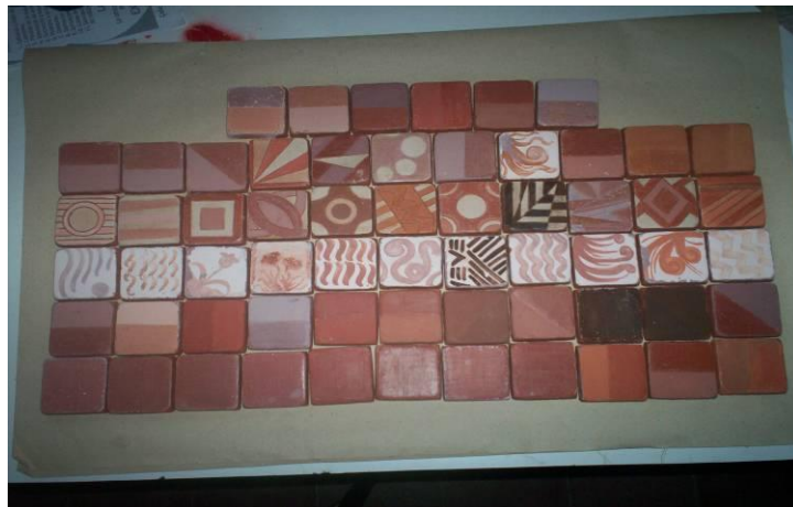
Figura N. 46 engobes colorantes con los tres engobes blancos base
