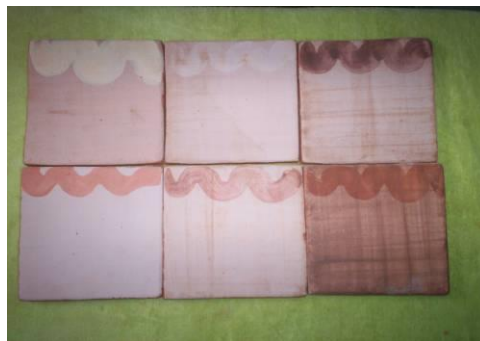
Figura N. 57 pruebas de engobe café ausol 2
