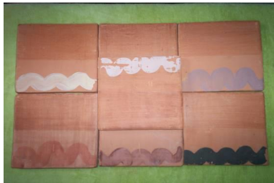
Figura N. 55. pruebas de engobe anaranjado san Juan
