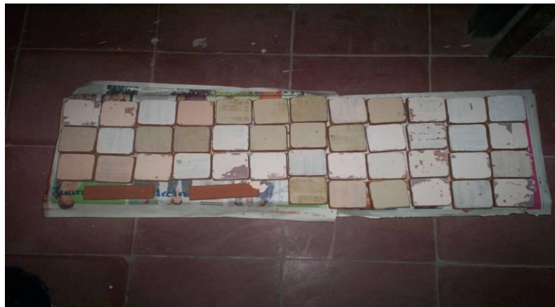
Figura N. 44 pruebas 3 engobes base blancos horno electrico
