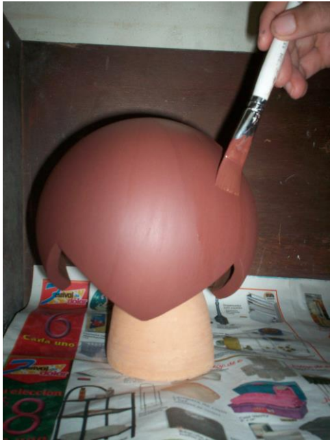
Figura N 76 aplicación del engobe combinado
