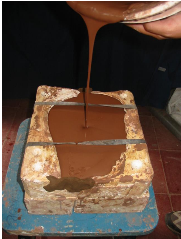
Técnica de vaciado
