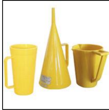
Figura 5. Embudo de Marsh y recipiente con marca de aforo a un cuarto de litro. Fuente: (Direct Industry, s.f.).
