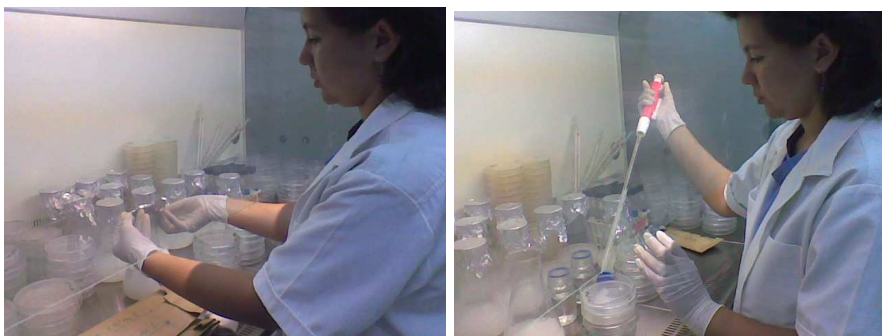
Fig. No 7: Preparación de muestras en diluciones decimales bajo la campana de flujo laminar.
