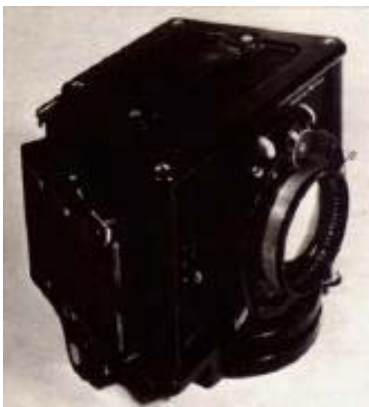
Cámara diseñada por Jospé en 1925 para tomar fotografías en color. Solamente podía hacerse una foto antes de volver a cargarla 16 .
