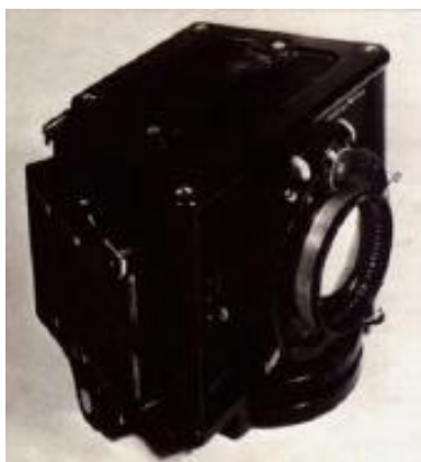
Cámara diseñada por Jospé en 1925 para tomar fotografías en color. Solamente podía hacerse una foto antes de volver a cargarla 15 .
